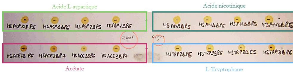
Figure 129 : Photographie de la plaque de silice sur laquelle ont été déposés chacun des pics à analyser au  $\beta$ -imager.
