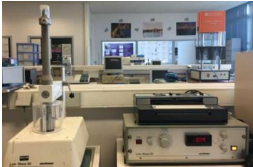
Figure III.19 Viscosimètre Contraves Low Shear 30 utilisé pour mesurer la viscosité des solutions étudiées
