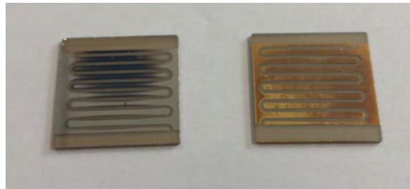
Figure III-13 : Photographie des deux couches possédant des électrodes en platine et en or après mesures électriques sous CO 2 .
