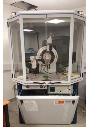
Figure II-9 : Diffractomètre BRUKER D8 utilisé en incidence rasante.
