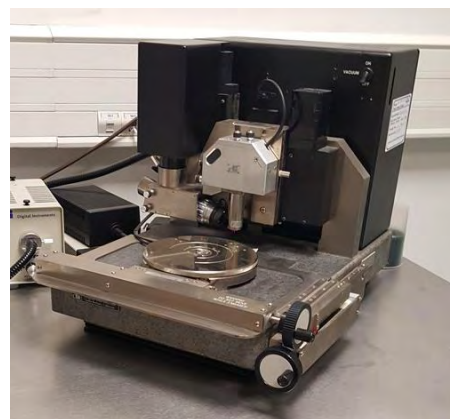
Figure II-10 : Principe de fonctionnement et photographie d'un microscope à force atomique.
