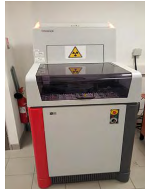
Figure II- 8 : Diffractomètre BRUKER D4 utilisé en configuration Bragg-Brentano \theta - 2\theta .
