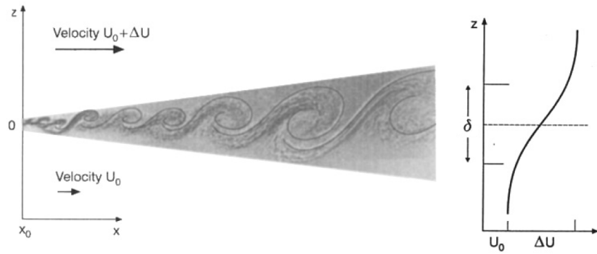
FIGURE 1.6: Ecoulement de couche de mélange obtenu à l'aval d'une plaque séparant deux fluides de vitesses différentes et le profil de vitesse associé (Raupach et al., 1996)
