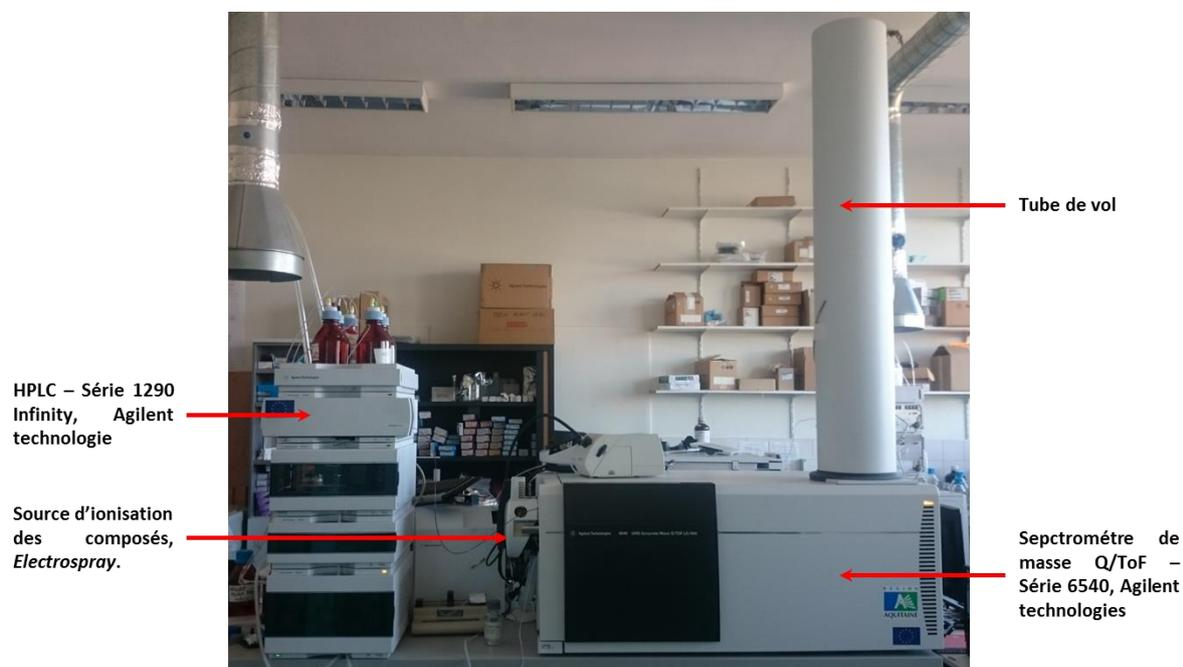
**Figure 37** : LC-QTOF (Agilent Technologies, Santa Clara, USA).
