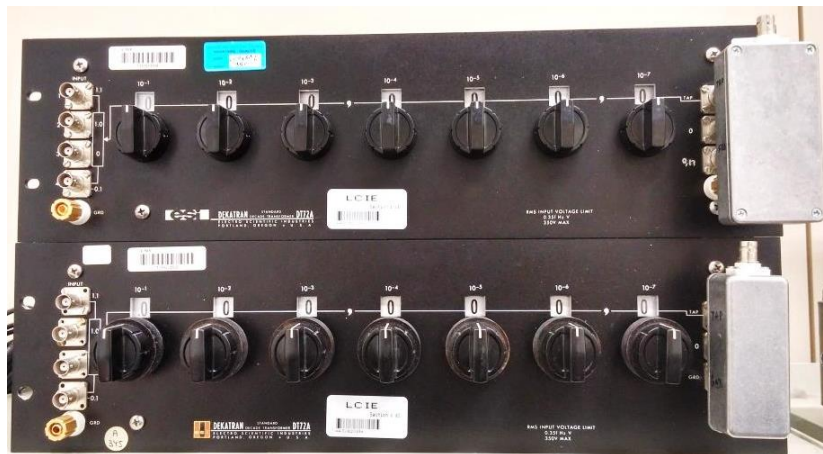
Figure 81 : Diviseurs de tension inductifs DT72A utilisés dans le banc d'étalonnage
