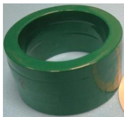
Figure 54 : Tore employé pour réaliser l'enroulement magnétisant
