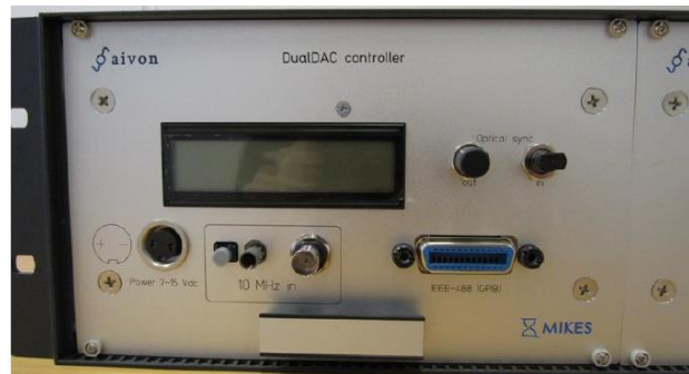
Figure 121 : Unité de commande numérique du générateur de signaux Aivon Oy DualDAC™
