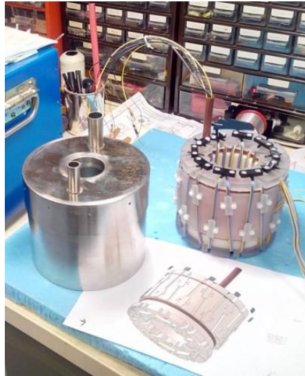
Figure 64 : Photographie de l'enroulement métrologique et de l'écran magnétique en mumétal
