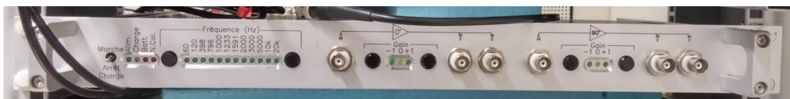
Figure 85 : Face avant boîtier injection (conçu au LNE) employé pour l'étalonnage des transformateurs
