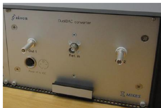
Figure 122 : Unité de conversion analogique du générateur de signaux Aivon Oy DualDAC™
