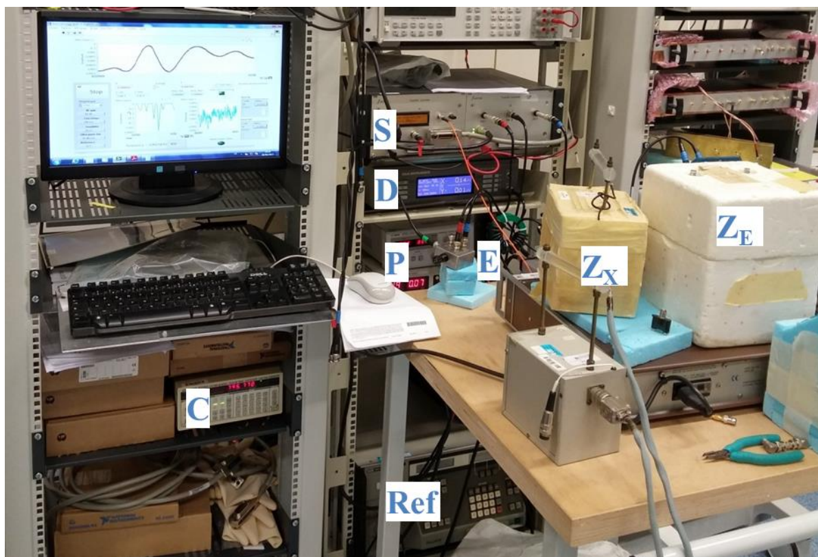
Figure 118 : Photographie du pont de comparaison automatique présentant les impédances en comparaison Z_X et Z_E (définies en deux paires de bornes), la source S alimentée par des alimentations P (Agilent E3620A et TTI EL302D), le détecteur D (SR modèle 7265), les égalisateurs de courant E, l'alimentation pour la référence de tension Ref (Fluke 5440A), ainsi que la source d'horloge de 10 MHz C (SRS modèle DS345).
