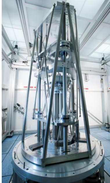
Figure 9 : Nouveau condensateur calculable du LNE en cours de construction (photographie LNE)
