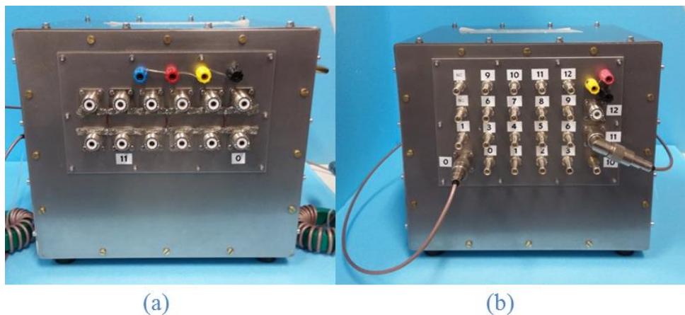
Figure 67 : Photographie représentant la face arrière (a) et la face avant (b) de l'autotransformateur étalon double étage RK120
