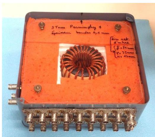
**Figure 53 : Autotransformateur étalon de la précédente génération (AT1)**
