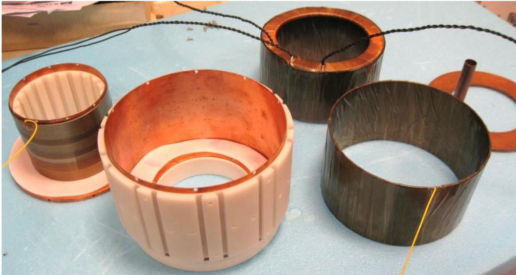
**Figure 61 : Réalisation des écrans magnétiques et électriques de l'étage magnétisant**
