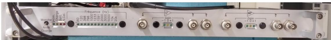
Figure 85 : Face avant boîtier injection (conçu au LNE) employé pour l'étalonnage des transformateurs
