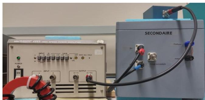
**Figure 77 : Amplificateur de puissance et transformateur d'alimentation de rapport 4,5**
