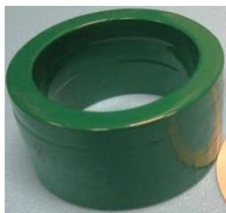
**Figure 54 : Tore employé pour réaliser l'enroulement magnétisant**
