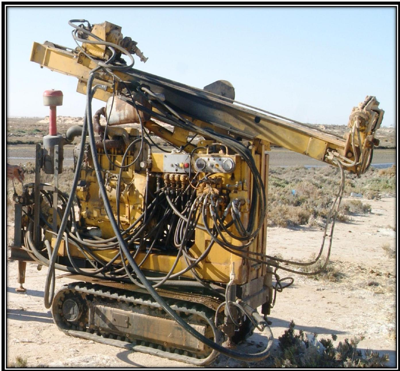
*Figure 2.1 : Foreuse hydraulique type Bonne Esperance*
