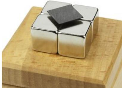
**FIGURE 4.1** – Mise en évidence du diamagnétisme du graphite : lévitation à température ambiante de graphite pyrolytique grâce à un agencement quadripolaire d’aimants néodymes. Empruntée à <https://www.supermagnete.fr/>
