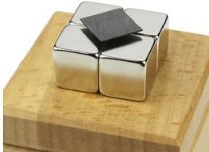
FIGURE 4.1 – Mise en évidence du diamagnétisme du graphite : lévitation à température ambiante de graphite pyrolytique grâce à un agencement quadripolaire d’aimants néodymes. Empruntée à https://www.supermagnete.fr/
