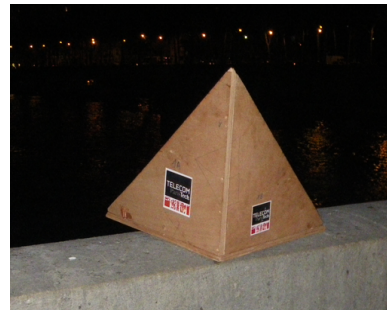
(d) Grand corner reflector pointant à 90° par rapport à la trajectoire du satellite
