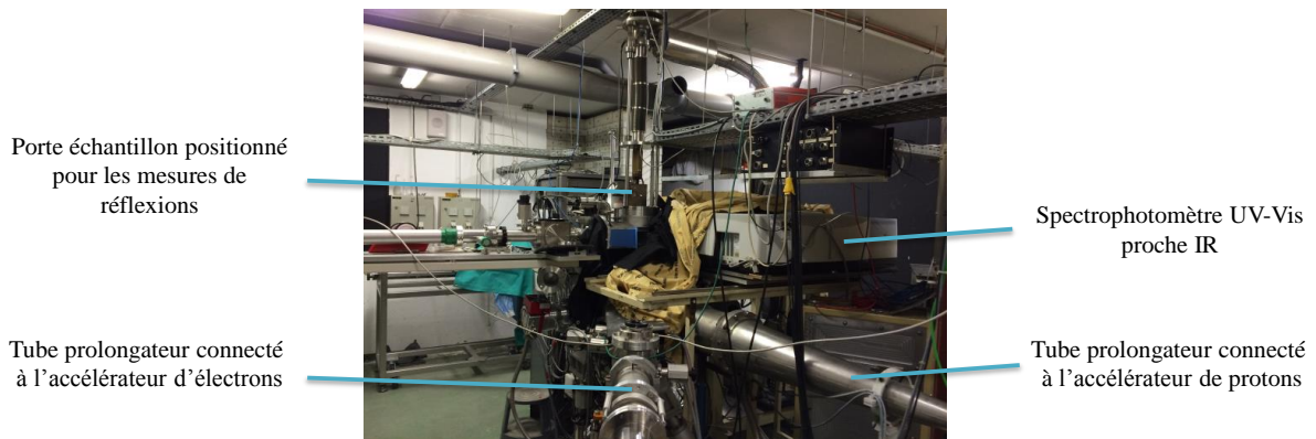
Figure II-6. Enceinte SEMIRAMIS connectée aux accélérateurs de protons et d'électrons
