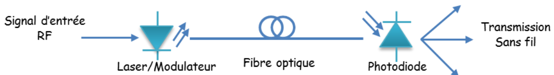
Figure 1-7: Schéma synoptique d'une liaison RoF.
