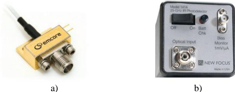
Figure 2-19 : Photodétecteurs exploités dans cette étude : a) modèle 2522 EMCORE [87] – b) modèle 1414 de New Focus [88].
