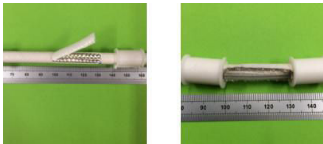
Figure 5.25: Défaut de blindage sur un câble coaxial.
