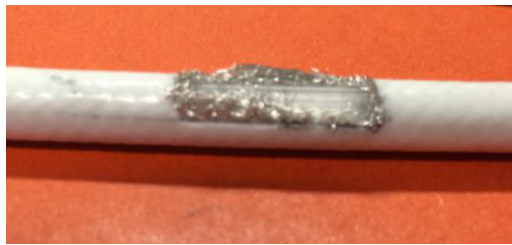
Figure 5.13: Défaut de blindage (partiellement coupé).
