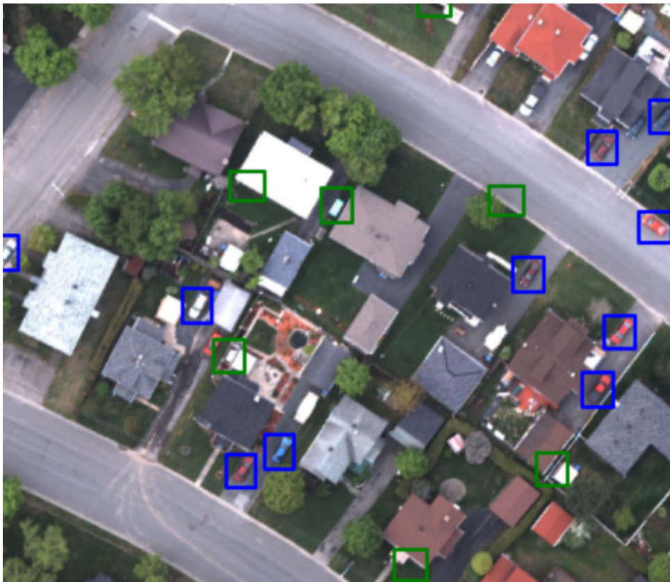
FIG. 4.18 : Détections de véhicules utilisant notre méthode de fusion de modèles. Les détections en bleu sont les TP , les détections en vert sont les FP.
