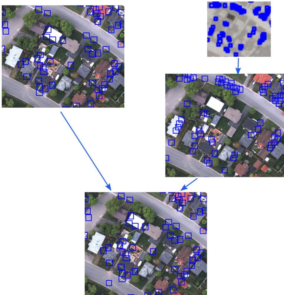
FIG. 4.7 : Illustration de la fusion entre les hypothèses de détection du domaine optique et du domaine infrarouge. Les hypothèse de détection du domaine infrarouge sont projetées dans le domaine optique puis la fusion grâce à la NMS est effectuée.
