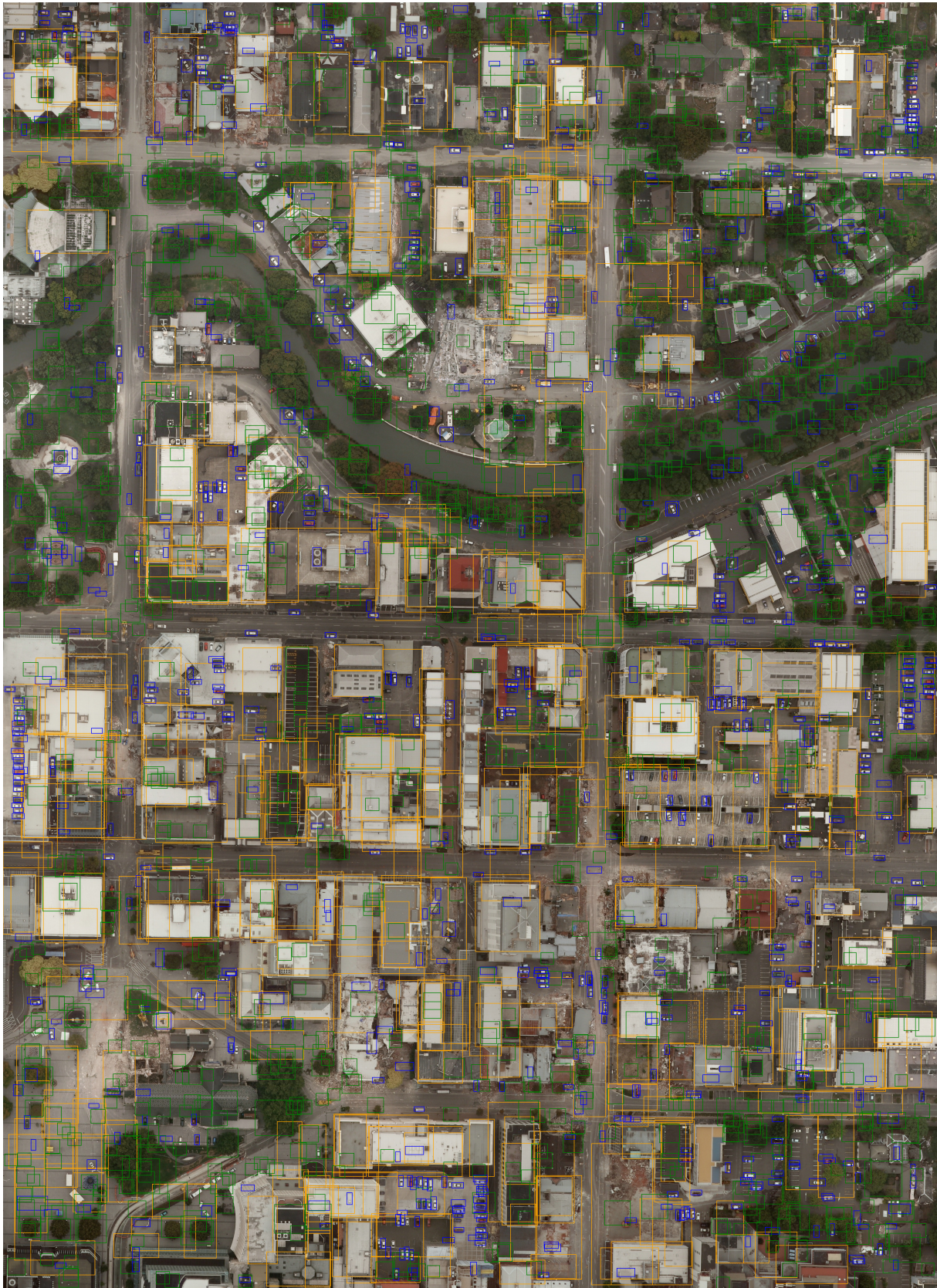
FIG. 4.10 : Détections du DtMM sur l'image de test de la base Christchurch. Les détections de voiture sont en bleu, celles de bâtiments sont en jaune et celles de végétation en vert. On observe que d'un point de vue global le détecteur arrive à reconnaître les objets des différentes catégories même si il est peu précis dans le cas des bâtiments et des arbres.
