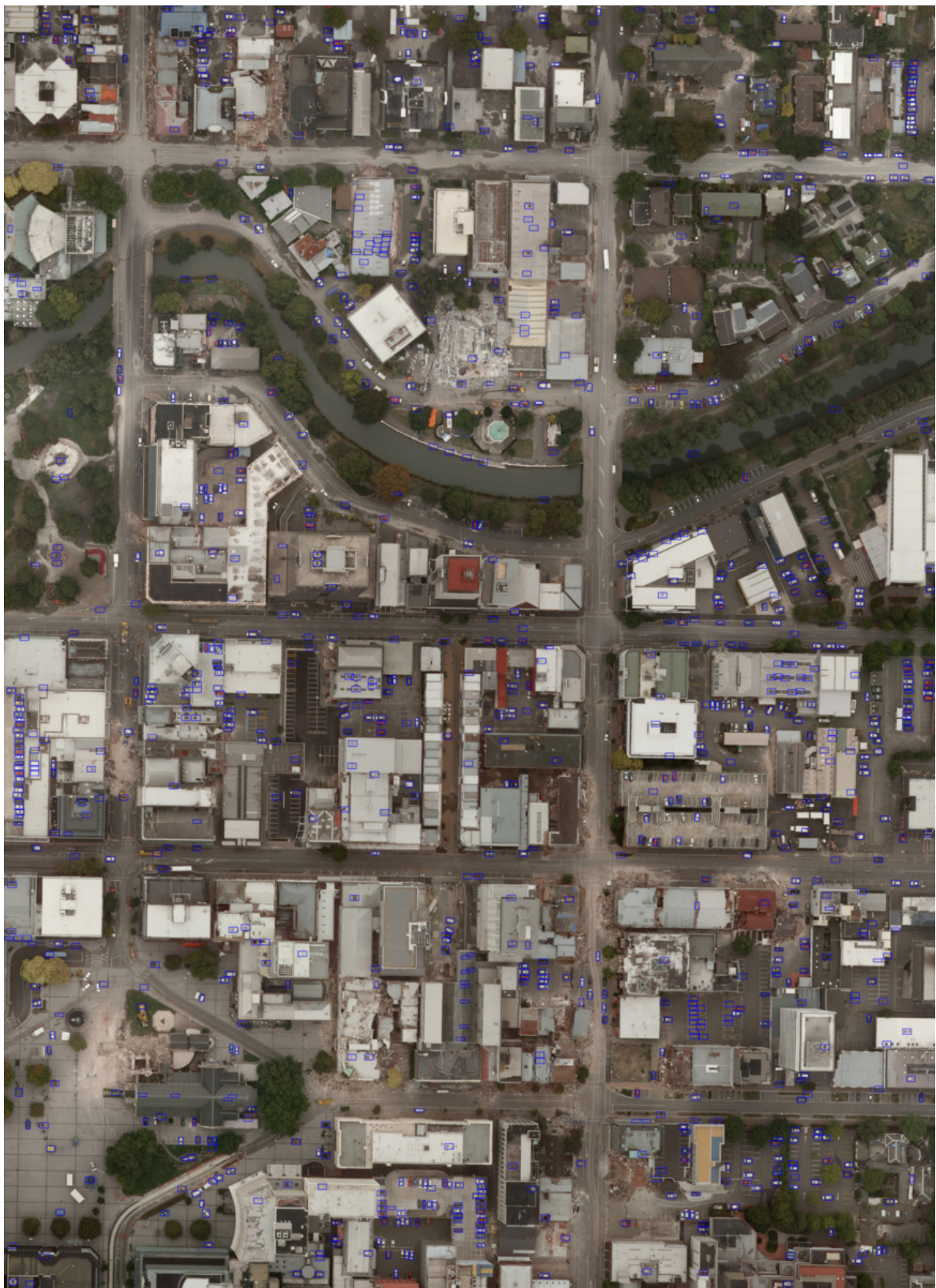
FIG. 4.11 : Hypothèses de détections renvoyées par le DtMM pour la détection de véhicules sur l'image de test de la base Christchurch.
