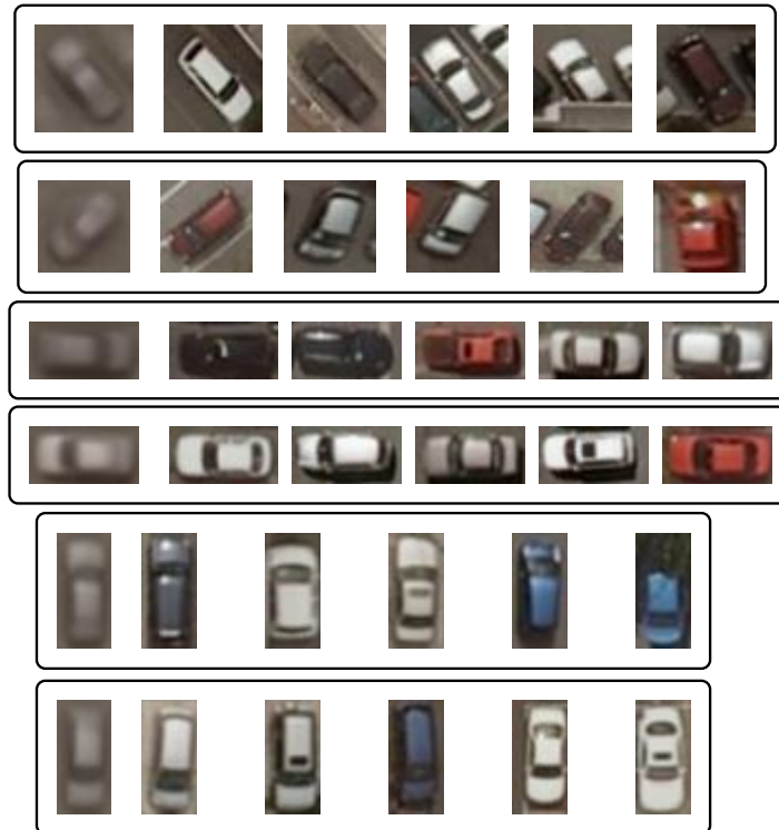
FIG. 3.16 : Partitionnement des exemples de la base Christchurch en 3 \times 2 sous-catégories pour la classe voiture. Nous avons amélioré le partitionnement des sous-catégories trouvées en figure 3.14 pour finalement obtenir des sous-catégories plus homogènes. On observe cette fois ci que chacune des sous-catégories est composée de véhicules ayant tous la même orientation.
