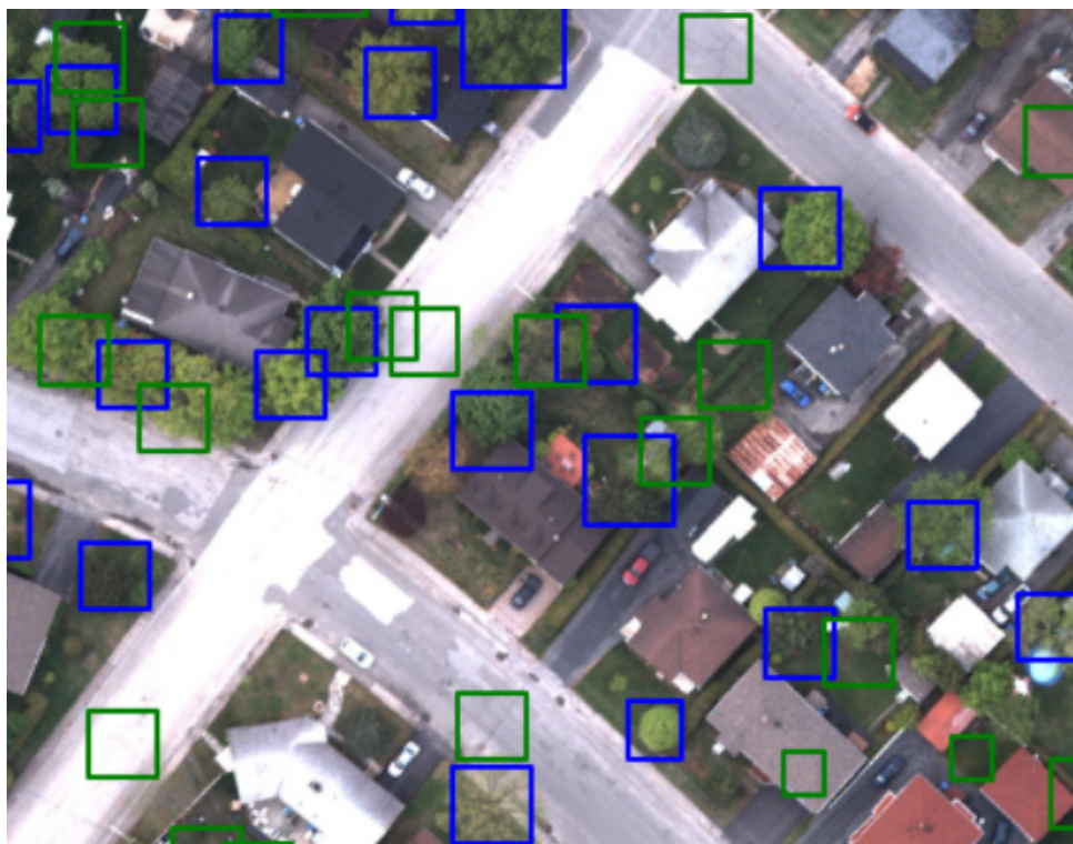
FIG. 4.20 : Détections d'arbres utilisant notre méthode de fusion de modèles. Les détections en bleu sont les TP , les détections en vert sont les FP.
