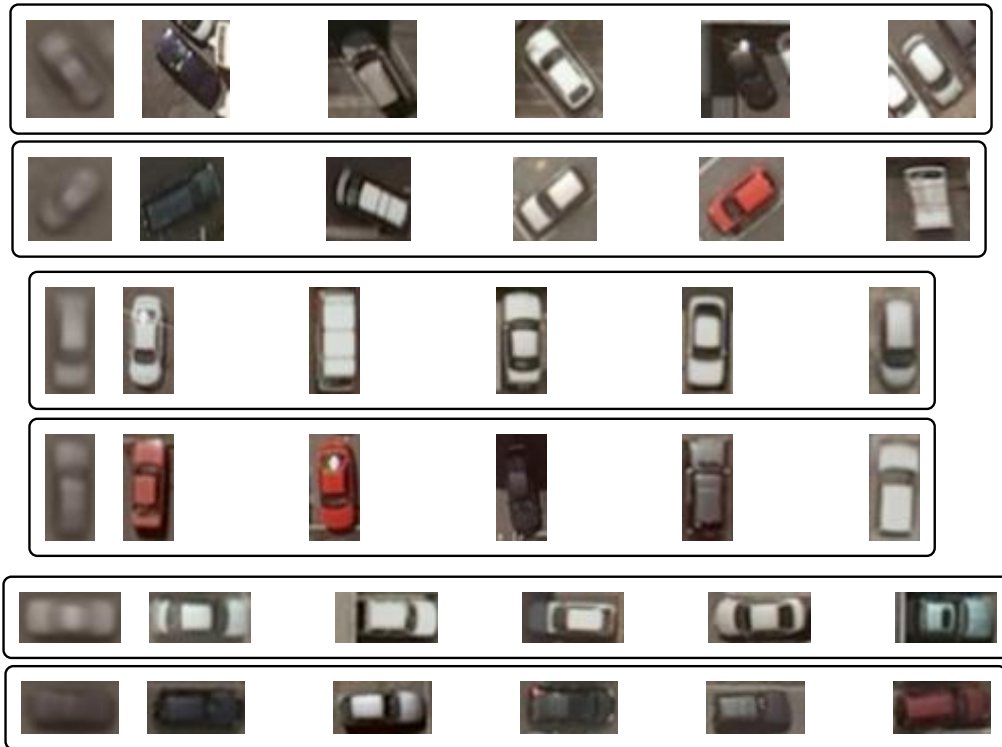
FIG. 3.18 : Partitionnement des exemples de la base Christchurch en 3 \times 2 sous-catégories pour la classe voiture en utilisant des GMM pour chaque étape.
