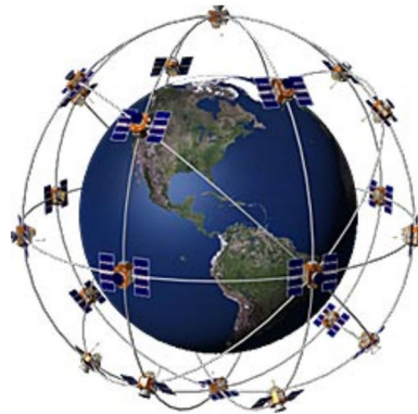
FIGURE A.1 – Constellation des satellites GPS avec 6 orbites circulaires inclinées de 55^\circ par rapport au plan de l'équateur, et décalées en longitude de 60^\circ .
