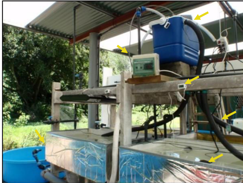
Figure 29. Photo d'une partie du dispositif en place lors des expériences de réchauffement. Les flèches indiquent les différents composants du dispositif, à savoir : le bac de chauffe (en bleu), les quatre aquariums entourés de couvertures de survie, un afficheur de la température du bac de chauffe (boîtier vert), les tuyaux entourés d'une gaine isolante noire, les thermomètres digitaux blancs accrochés au-dessus des aquariums, la sonde de relevés des aquariums et la pompe de brassage.
