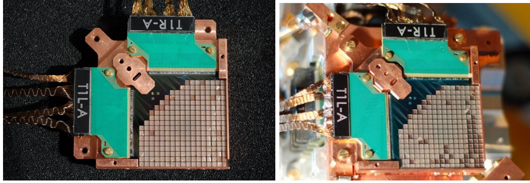
FIGURE 5.20 – Gauche : La matrice P41 en avril 2015 après fixation et bonding sur son support thermo-mécanique. À ce stade, on compte déjà une douzaine de pixels brisés, répartis sur les bords de l'échantillon. Droite : La même matrice en mai 2016 après de nombreuses mises en froid dans le cryostat. L'état de la matrice s'est clairement dégradé dans le temps, révélant les zones les plus fragiles qui coïncident avec les zones sur-gravées. Notons qu'une matrice venant d'être achevée compte la plupart du temps moins d'une demi-douzaine de pixels cassés. Photographies : Damien Prêle
