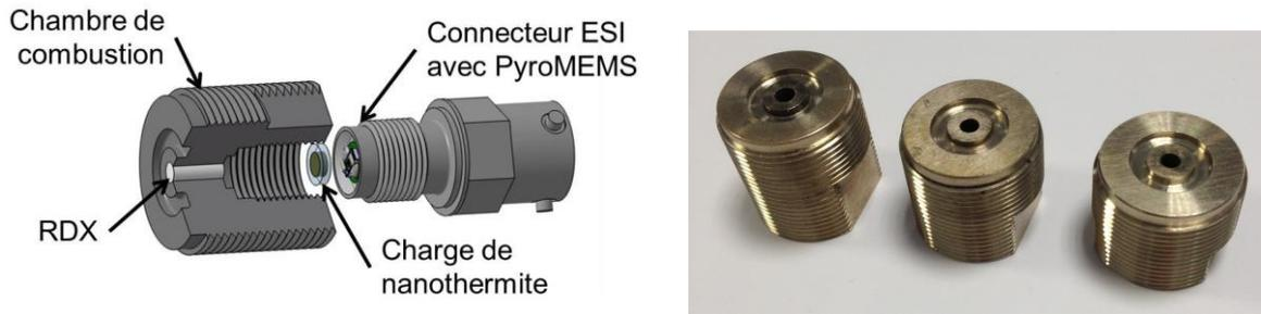
Figure IV.4 : (à gauche) Schématisation éclaté 3D en coupe d'une chambre non instrumentée avec les substances pyrotechniques et le PyroMEMS ;
