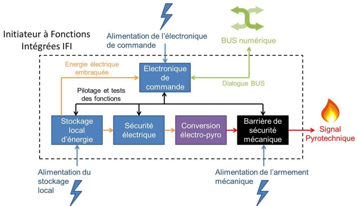
Figure I.15 : Schéma bloc fonctionnels de l'IFI.
