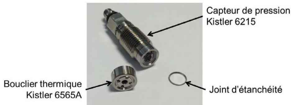
Figure III.25 : Photo du capteur de pression Kistler 6215 avec un bouclier thermique et son joint d'étanchéité.
