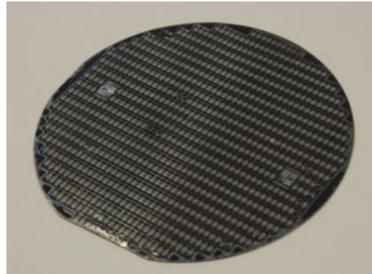
Figure I.24 : Photo d'un wafer de PyroMEMS avant discrétisation.
