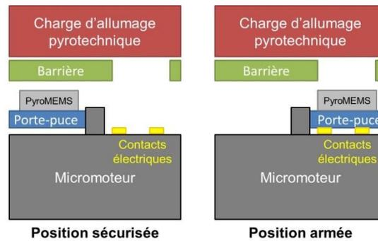
Figure I.17 : Schématisation de l'armement mécanique de l'IFI.
