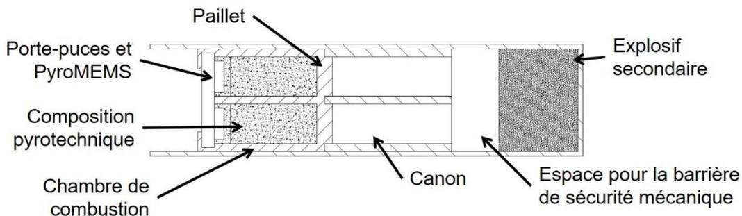
Figure II.3 : Schéma illustrant la solution bi-canons.
