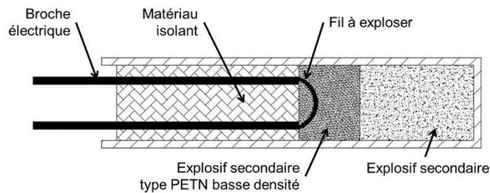
Figure I.28: Schéma d'un détonateur à pont explosé EBW.
