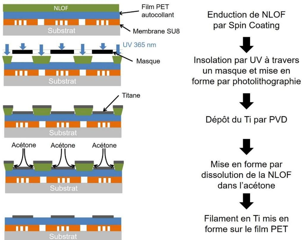
Figure II.18 : Schéma de principe du procédé de mise en forme par Lift-off du filament en titane.
