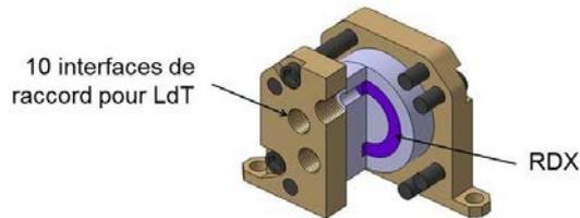
Figure I.10 : Schéma d'un Relais Multivoies (RMV) Ariane 5.
