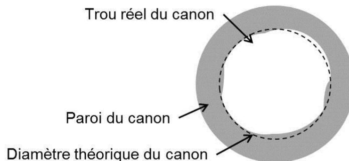
Figure II.9 : Illustration des défauts d'usinage du canon.
