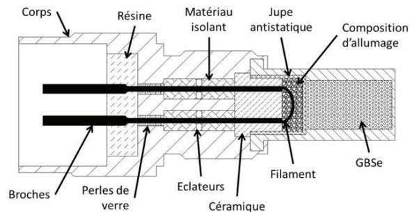
Figure I.6 : Schéma d'un inflammateur ou étoupille sur Ariane 5.
