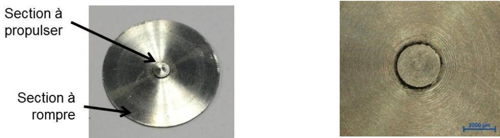
Figure IV.5 : (à gauche) Photo vue d'ensemble du paillet ;
