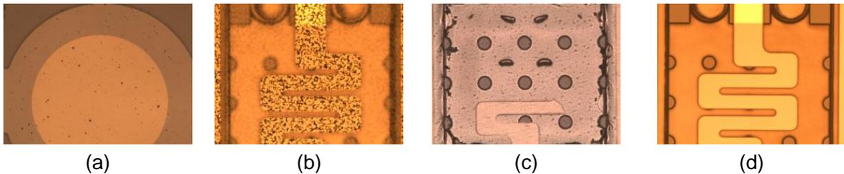
Figure II.22 : Photos des surfaces du dépôt de Ti et d'Or sur le film (a) HIFI Industrial Film PMX727 ; (b) SigmaGraph Shield AG<sup>2</sup> ; (c) 3M OCA 8211 ; (d) LINTEC A116-75K2P.
