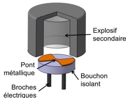
Figure I.29 : Schéma d'un EBW avec un pont métallique.
