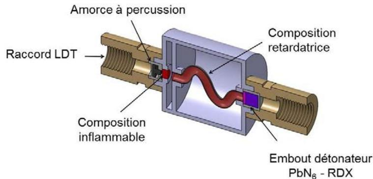
Figure I.11 : Schéma d'un Relais Retard (RR) sur Ariane 5.
