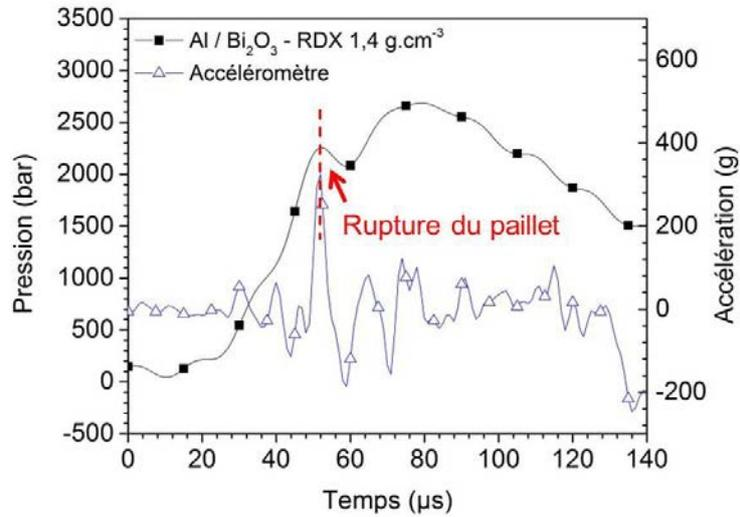
Figure IV.18 : Pression dans la chambre et signal de l'accéléromètre en fonction du temps pour un paillet de 0,5 mm et une composition pyrotechnique Al / Bi<sub>2</sub>O<sub>3</sub> - RDX 1,4 g.cm<sup>-3</sup>.
