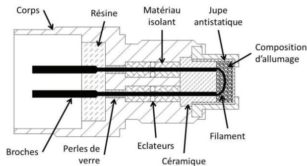
Figure I.5 : Schéma d'un initiateur pyrotechnique sur Ariane 5.
