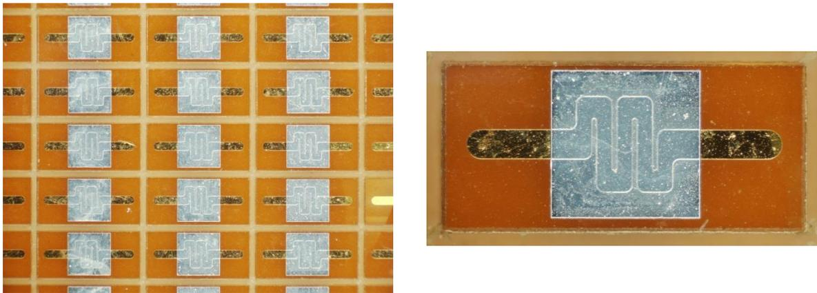
Figure II.24 : (à gauche) Photo de plusieurs PyroMEMS sur Pyrex Kapton ; (à droite) Zoom sur un PyroMEMS où on voit les aspérités du Kapton.
