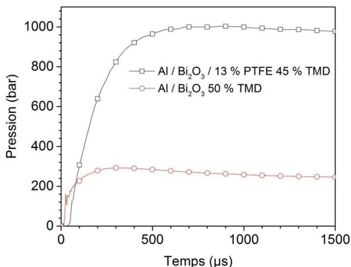
Figure III.16 : Courbes de pression en bombe manométrique de la nanothermites Al / Bi<sub>2</sub>O<sub>3</sub> avec et sans PTFE.
