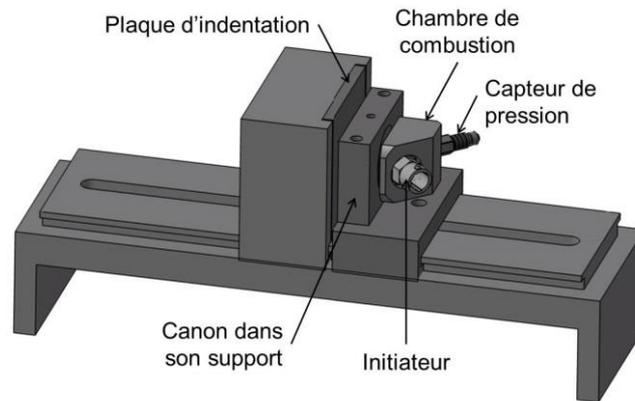
Figure IV.1 : Vue schématique du banc d'essai.
