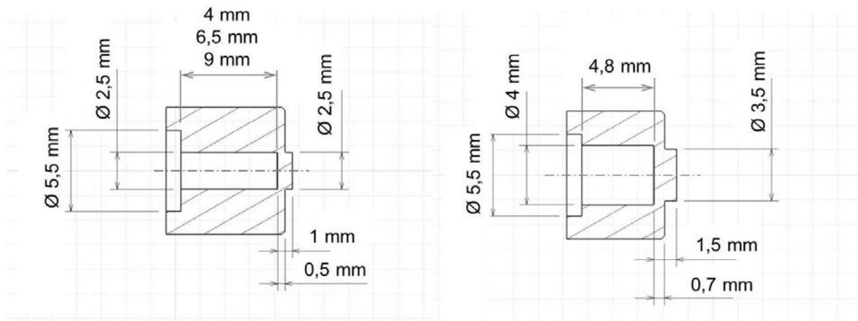
Figure IV.27 : (à gauche) Plan de la Chambre de combustion / Paillet de la configuration bi-cannons avec les principales dimensions ; (à droite) Plan de la Chambre de combustion / Paillet de la configuration mono-canon avec les principales dimensions.
