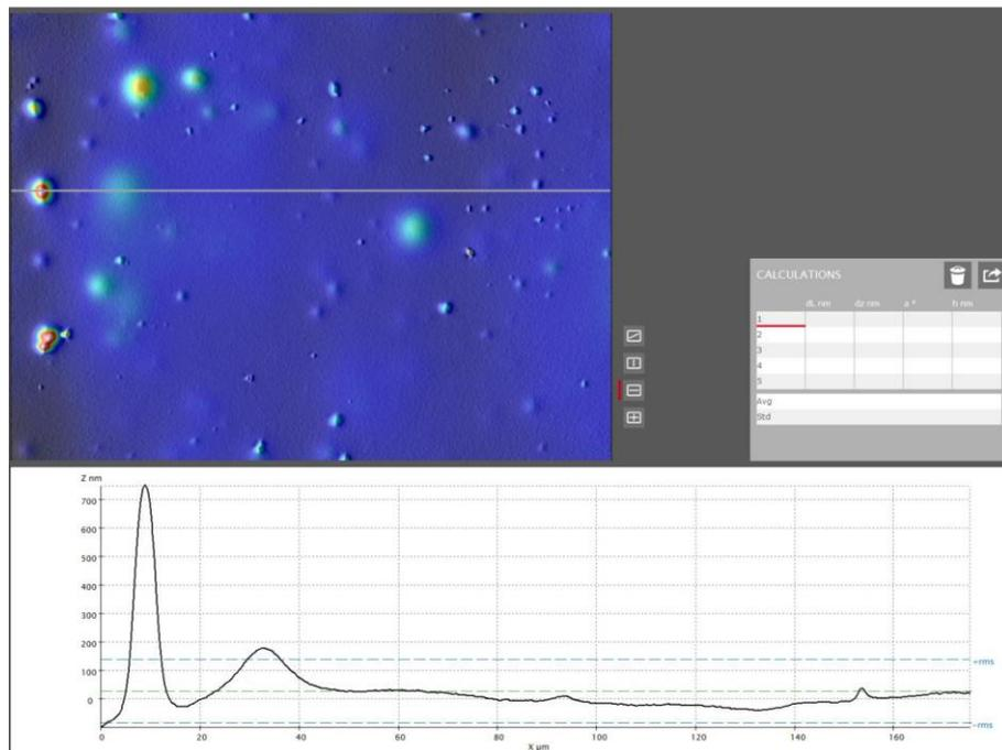
Figure II.23 : Image de la surface du film Kapton et le profil de sa surface au niveau du trait sur l'image (réalisé par le CNES de Toulouse).
