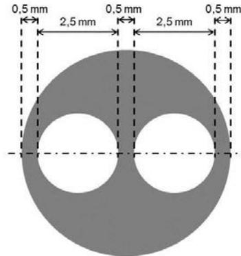
Figure II.4 : Schéma montrant la disposition des chambres de combustion de 2,5 mm de diamètre pour la solution bi-canons dans un diamètre de 6,5 mm.
