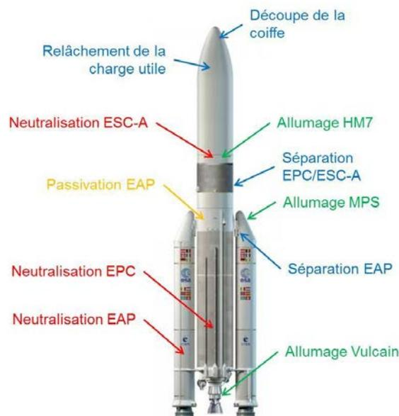
Figure I.1 : Systèmes pyrotechniques sur lanceur Ariane 5.
