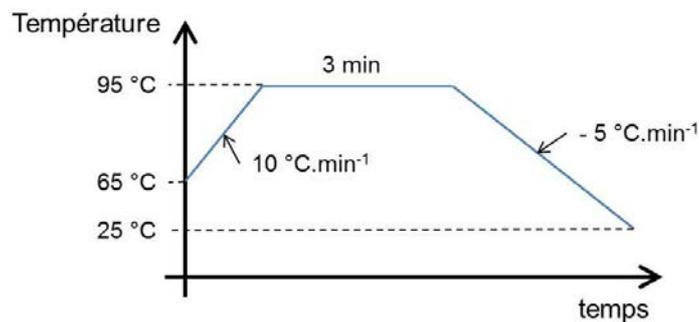
Figure II.15 : Profil de température pour l'étape de recuit de la résine époxy SU8 de 100 µm d'épaisseur après insolation aux UV.
