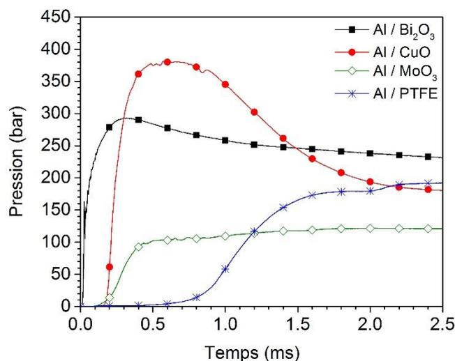
Figure III.14 : Evolution temporelle de la pression en bombe manométrique dans un volume de 9 mm<sup>3</sup> pour les différents couples de nanothermites compactées à 50 % TMD.
