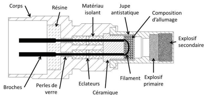
Figure I.7 : Schéma d'un détonateur sur Ariane 5.
