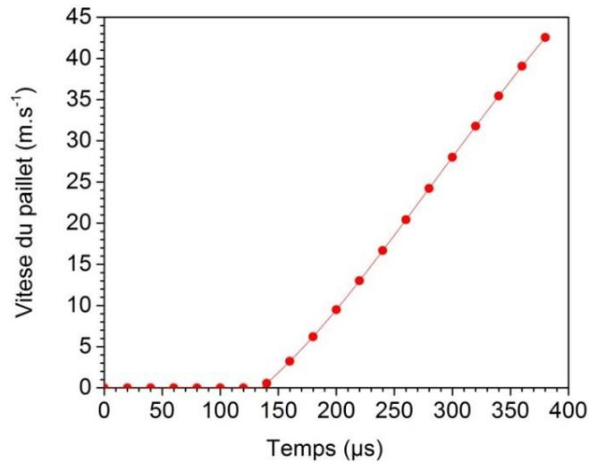
Figure III.29 : Courbe théorique de la vitesse du paillet en fonction du temps propulsée par la réaction de nanothermite  $Al / Bi_2O_3 + 5\% PTFE$  à partir de la pression théorique calculée par le modèle de balistique intérieure.
