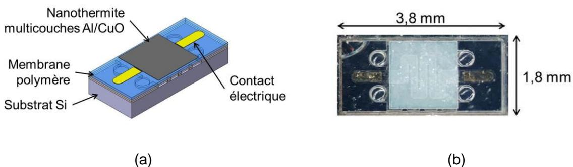
Figure I.25 : (a) Schéma d'un PyroMEMS ; (b) Photo face avant d'un PyroMEMS après découpe.
