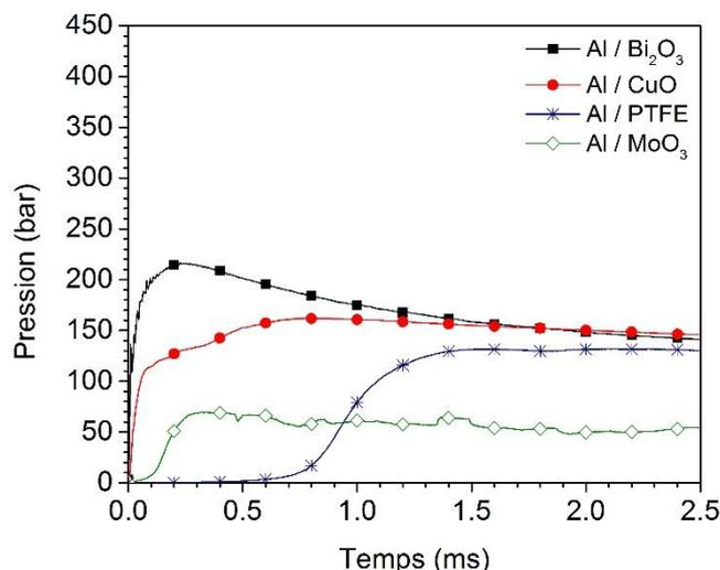
Figure III.15 : Evolution temporelle de la pression en bombe manométrique dans un volume de  $9 \text{ mm}^3$  pour les différents couple de nanothermite compacté à 30 % TMD.
