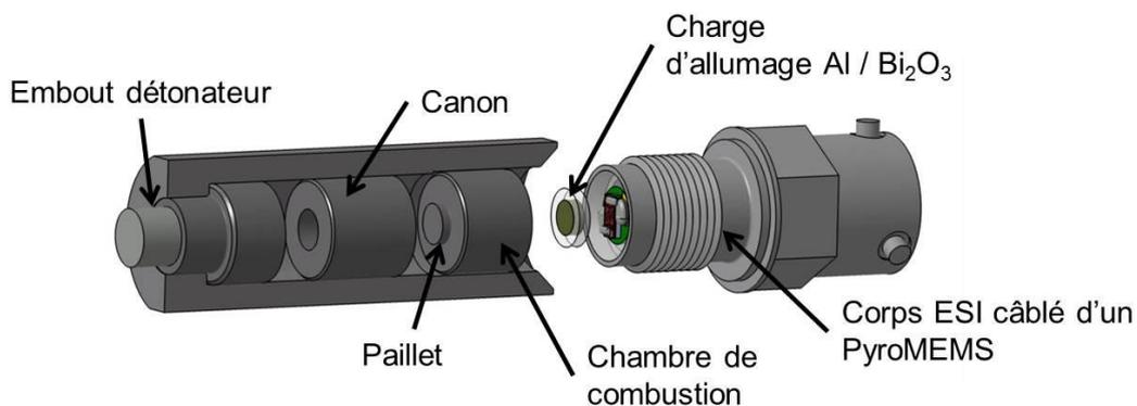
Figure IV.25 : Vue éclatée du démonstrateur montrant le paillet.
