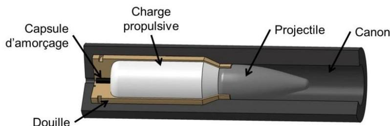
Figure III.17: Vue en coupe d'une munition dans un canon avec description des éléments constitutifs.
