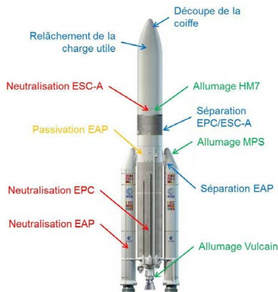
Figure I.1 : Systèmes pyrotechniques sur lanceur Ariane 5.
