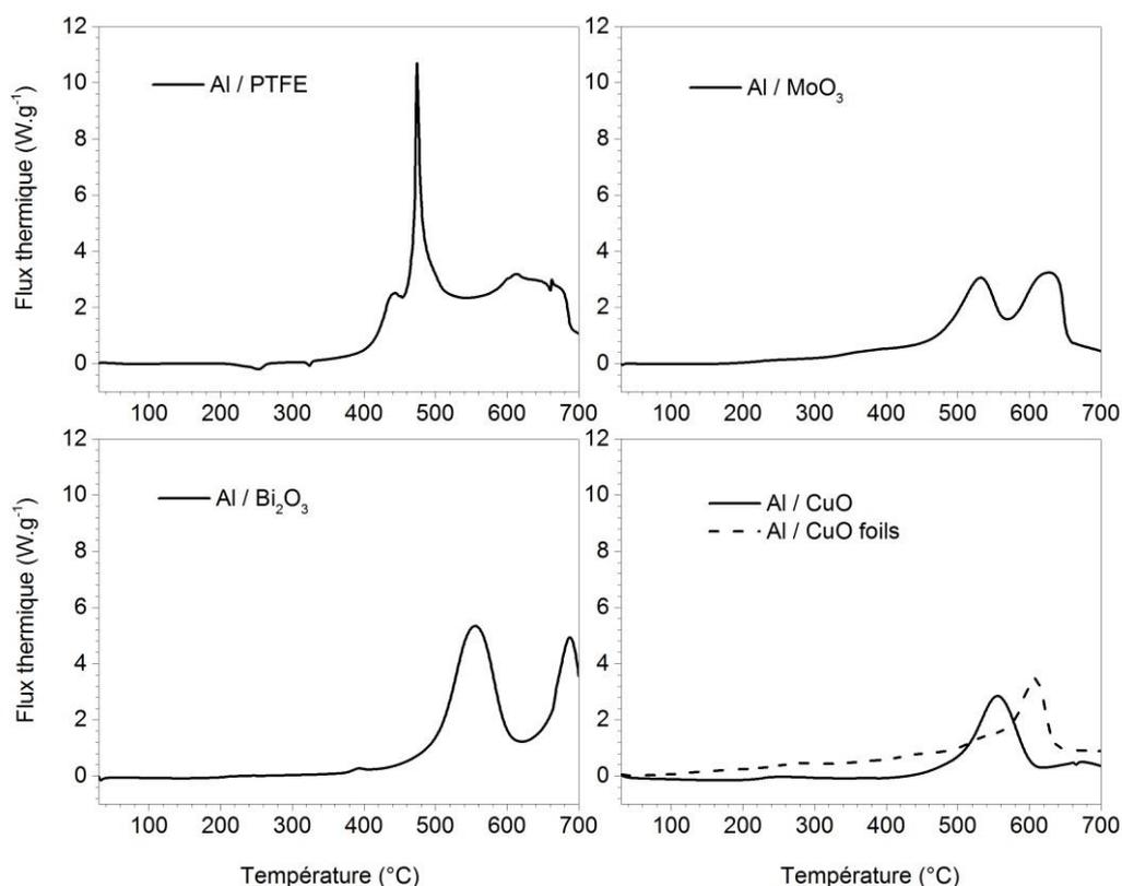
Figure III.8 : Courbes de mesure DSC des nanothermites Al / PTFE ; Al /  $\text{MoO}_3$  ; Al /  $\text{Bi}_2\text{O}_3$  ; Al / CuO à  $10$  °C.min<sup>-1</sup>.
