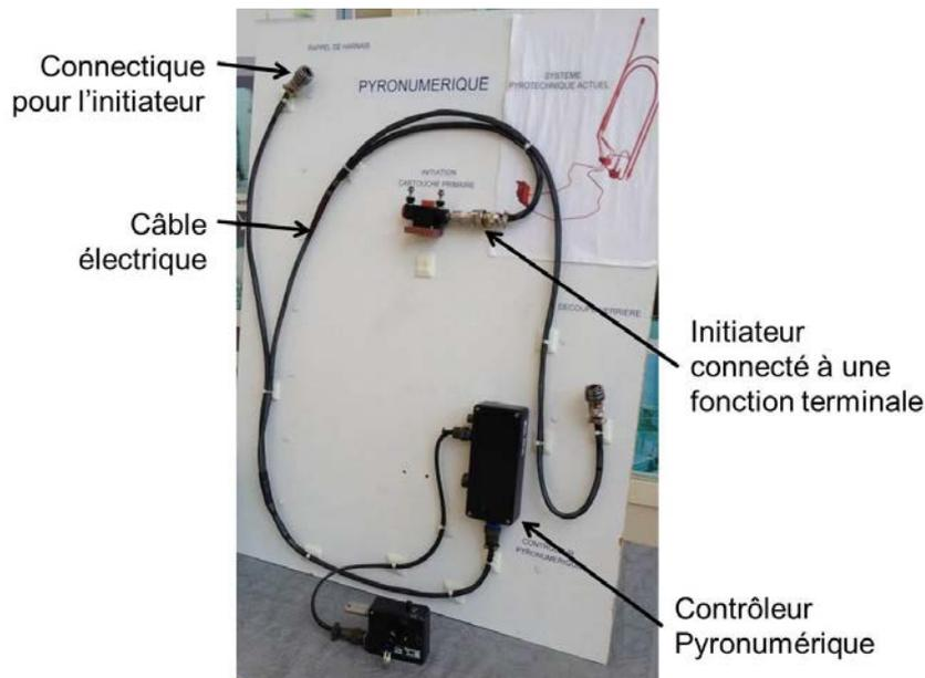
Figure I.14 : Photo de la maquette d'un système pyronumérique.
