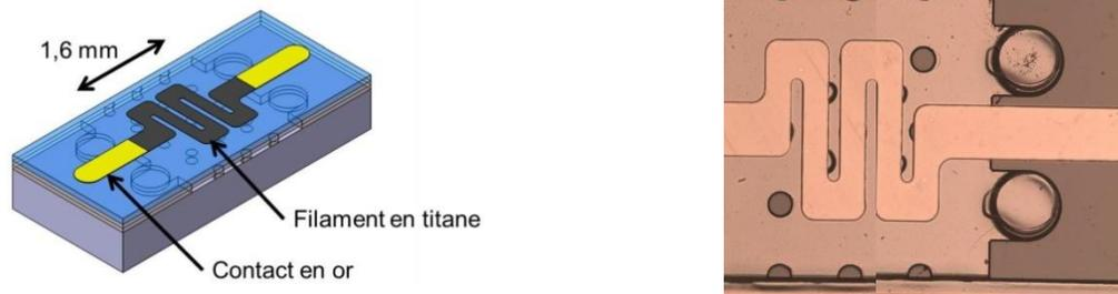
Figure II.13 : (à gauche) Schéma du filament et des contacts en or déposés sur une membrane polymère avant le dépôt de nanothermite ; (à droite) Photo du filament en titane réalisé selon le procédé développé dans la thèse de G. Taton.
