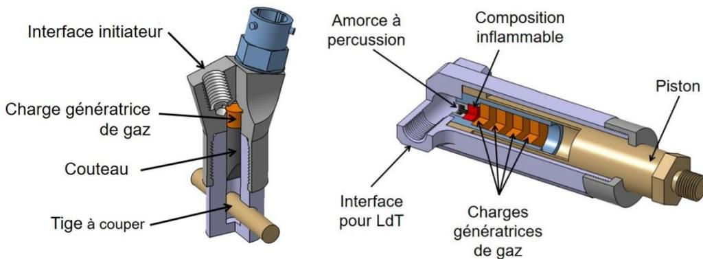
Figure I.12 : (à gauche) Schéma d'une cisaille pyrotechnique ;
