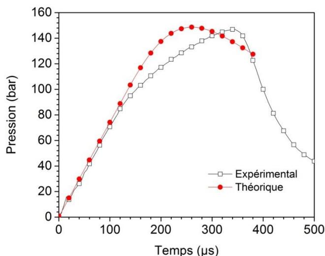
Figure III.26: Comparaison entre courbe expérimentale et théorique de la pression dans la chambre de combustion pour un essai et une simulation avec Al / Bi<sub>2</sub>O<sub>3</sub> + 5 % PTFE chargé à 50 % TMD et avec un projectile en inox de 200 μm d'épaisseur dans une chambre de combustion de 11 mm de long, 2,8 mm de diamètre et un canon de 5 mm.
