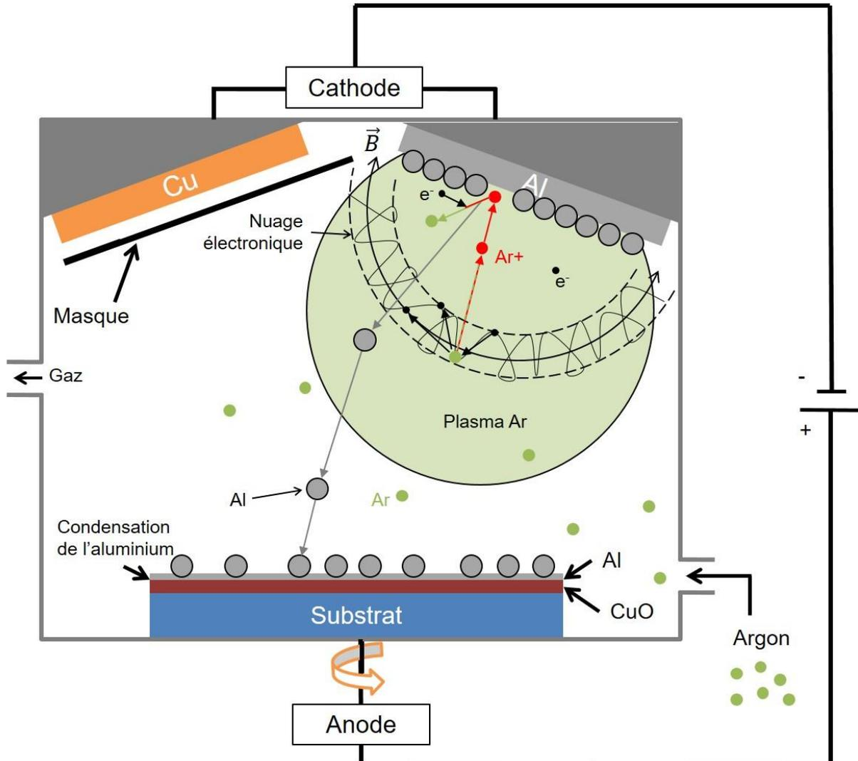
Figure 30 : Schématisation du dépôt d'Al par pulvérisation cathodique.
