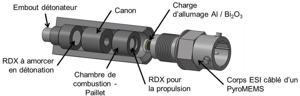
Figure IV.26 : Vue éclatée du démonstrateur montrant le RDX à amorcer en détonation et RDX utilisé pour la propulsion du paillet.
