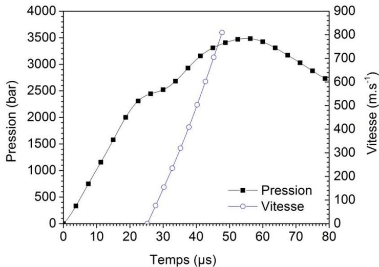
Figure IV.17 : Pression mesurée et vitesse calculée en fonction du temps correspondant à l'essai  $\text{Al} / \text{Bi}_2\text{O}_3 - \text{RDX} 1,7 \text{ g.cm}^{-3}$ .
