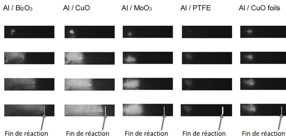
Figure III.10 : Images de la propagation de la flamme pour des nanothermites Al /  $\text{Bi}_2\text{O}_3$  ; Al / CuO ; Al /  $\text{MoO}_3$  ; Al / PTFE et Al / CuO sous forme de multicouches (foils).
