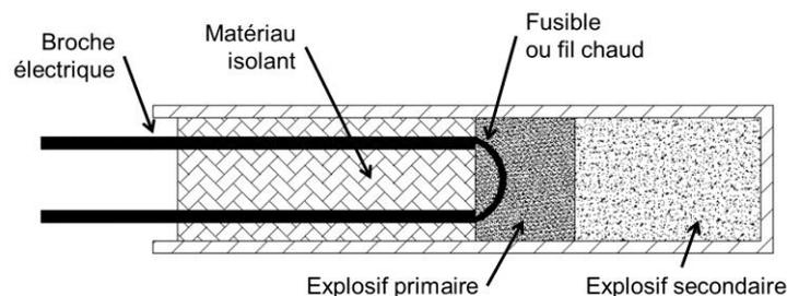
Figure I.26: Schéma d'une amorce détonateur à fil chaud.
