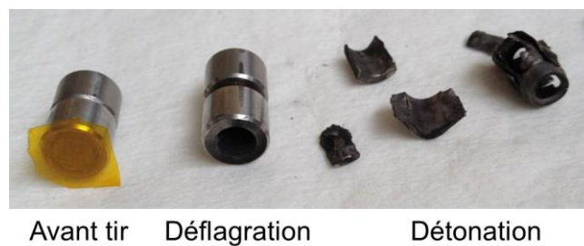
Figure IV.24 : Photos de la charge de RDX avant tir (Gauche) ; Après tir sans détonation (déflagration) (Centre) ; avec détonation (Droite) [IV.1].
