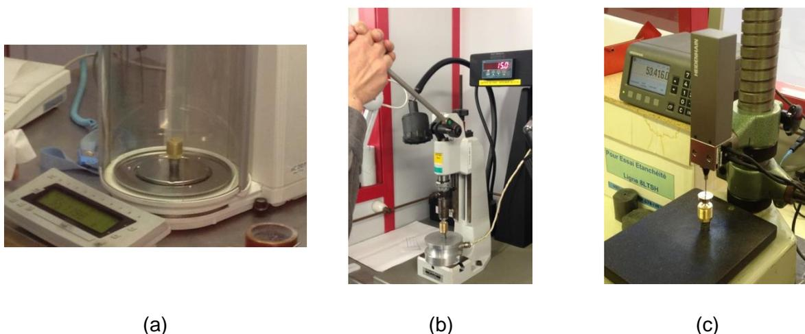
Figure IV.10 : Photos illustratives des différentes étapes : (a) pesée du système pour le chargement du RDX ; (b) compaction du RDX avec une presse manuelle à levier ; (c) mesure de la hauteur de compaction par palpeur [IV.1].
