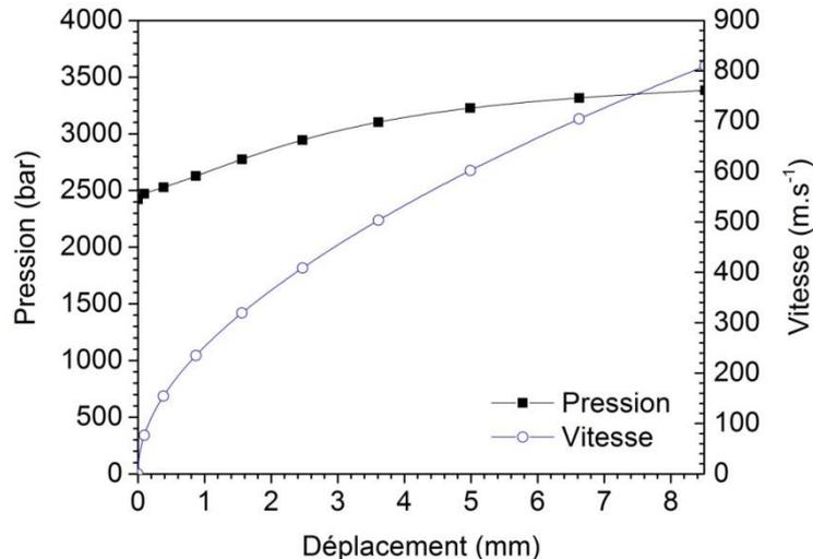
Figure IV.16 : Pression mesurée et vitesse calculée en fonction du déplacement du projectile dans le canon correspondant à l'essai Al / Bi<sub>2</sub>O<sub>3</sub> – RDX 1,7 g.cm<sup>-3</sup>.
