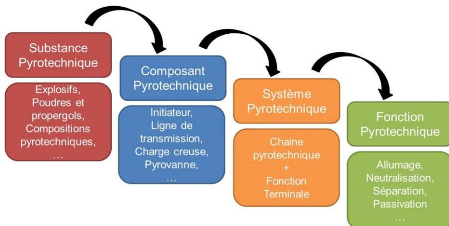
Figure I.2 : Cascade d'intégration des fonctions d'un système pyrotechnique.
