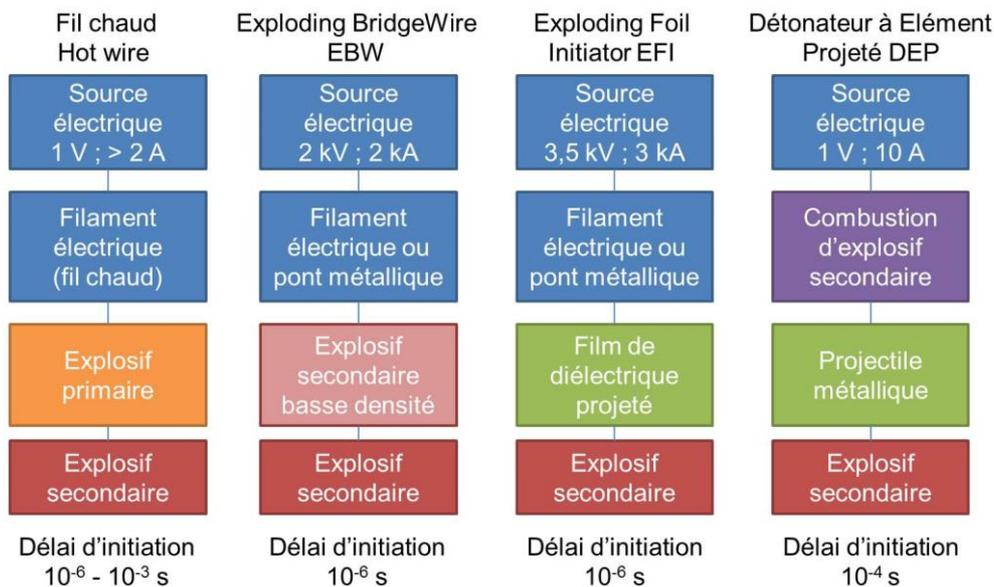
Figure I.32 : Tableau résumant les principales solutions capables de mettre en détonation un explosif secondaire.
