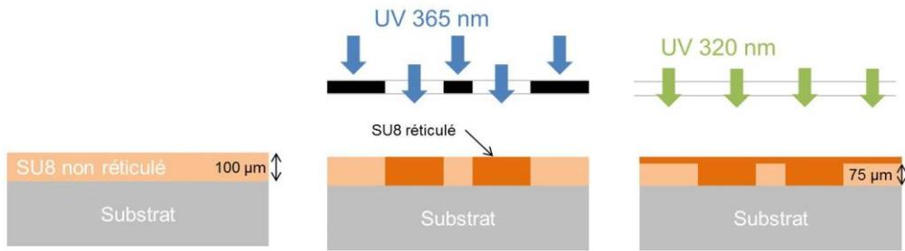
Figure II.14 : Schématisation du procédé de double insolation de la résine photosensible SU8 pour la formation des membranes SU8 sur piliers.
