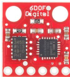
Fig. 5.5 Capteur IMU
