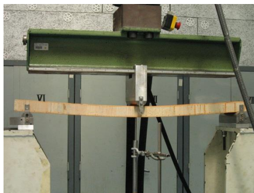
Figure IV-7 : Essai de flexion trois points sur sandwich
