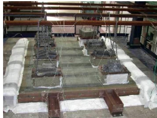
Figure V-7 : Application de la charge par des masses
