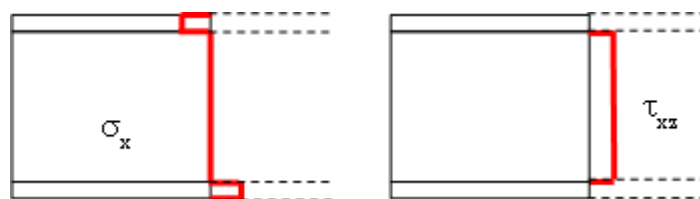
Figure VI-20 : Répartition de la contrainte dans l'épaisseur d'un sandwich
