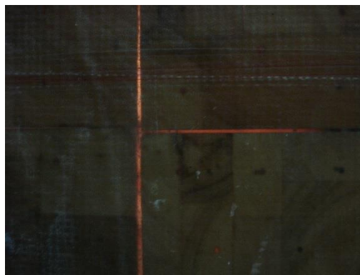
Figure V-2 : Décollement des blocs par fonte de la résine au cours d'un essai en température
