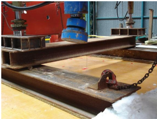
Figure V-6: Application de la charge via des poutres
