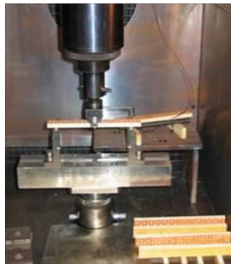
Figure IV-19 : Eprouvette testée en flexion 3 points
