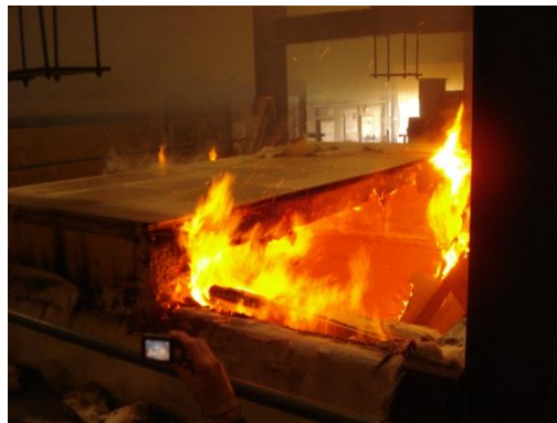
Figure IV-1 : Effondrement d'un pont en matériau combustible (Laboratoire d'Essai au Feu, Liège)
