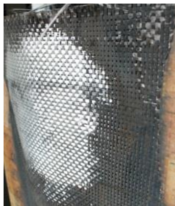
Figure 0-2: Les trois états du matériau : vierge, décomposé, fibres nues
