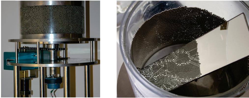
FIGURE III.4 – Photographies du premier montage imaginé par Osvanny RAMOS à Oslo. Le milieu granulaire était constitué de billes d'acier, et l'observation se faisait par le haut grâce à un miroir plan tournant.
