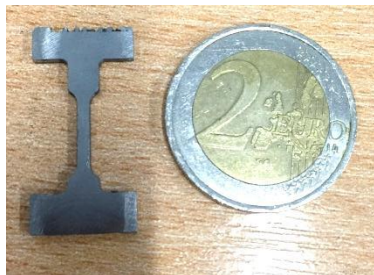
Figure II-6: Photo d'une éprouvette de traction in situ en titane Ti-6Al-4V après usinage
