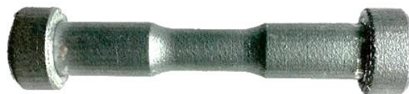
Figure II-3 : Photo d'une éprouvette de fatigue oligocyclique en titane Ti-6Al-4V, brute de fabrication
