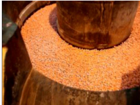
Figure II-5: Photo du bac de tribofinition dans lequel sont plongées les éprouvettes
