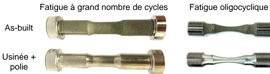
Figure II-4: Photos des éprouvettes de fatigue à faible (à gauche) et à grand nombres de cycles (à droite) brutes (en haut) et usinées et polies (en bas)
