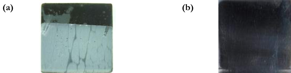
Figure 83 : Influence de la température au trempage T=20-22^\circ\text{C} (a) et T=55^\circ\text{C} (b) sur l'aspect des revêtements
