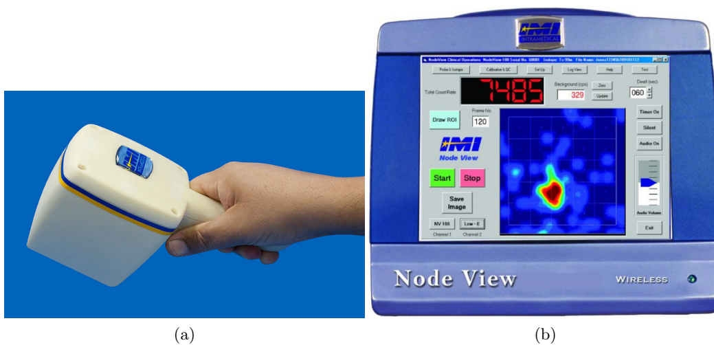
FIGURE 8.3 – Node View TM . (a) Caméra gamma. (b) Unité de contrôle avec visualisation de ganglion sentinelle, pour radiotracteur ^{99m}\text{T} . Illustrations : IMI Intramedical Imaging
