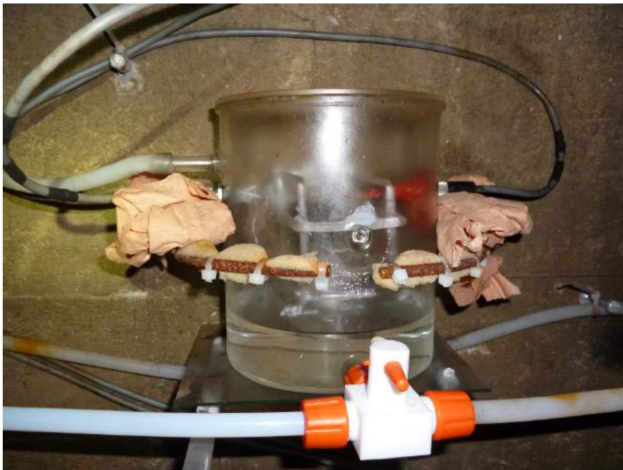
FIGURE A.3 – Photographie d'un pot d'inclinomètre longue-base. On y aperçoit l'eau, la fine couche d'huile qui repose dessus ainsi que l'armature interne en silice, maintenant le système de mesure.
