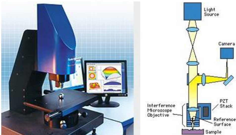
Figure 2-17 Talysurf CCI 6000 et schéma de principe
