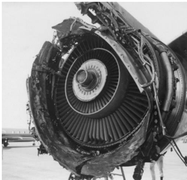
Figure 1-23 Rupture prématurée du disque fan en raison de l'effet dwell (RB211, le 10/01/1973) [54]
