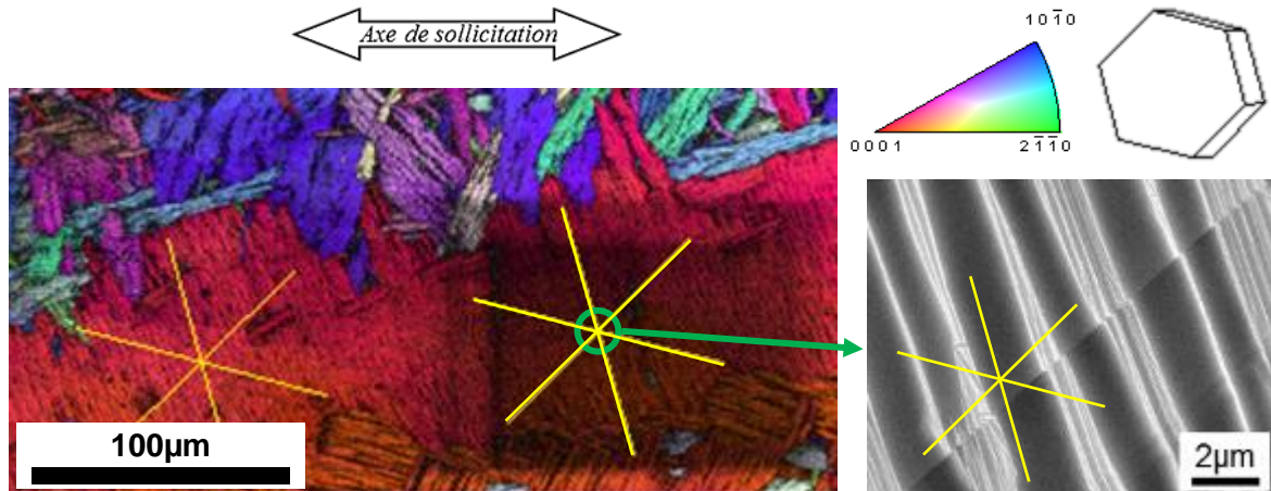
Figure 6-45 Détail de la cartographie EBSD au-dessus de la plume, code couleur IPF selon la normale à la surface
