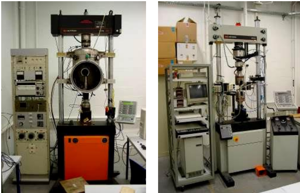
Figure 2-10 Machines de fatigue électromécaniques 1362 (gauche) et 8562 (droit)
