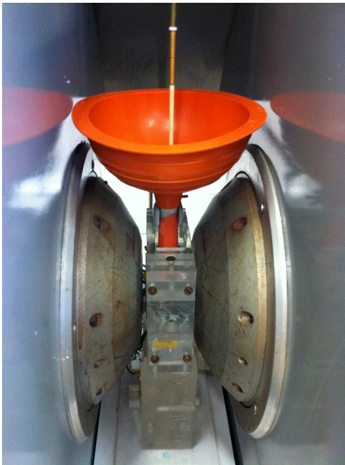
(a) Première version du cryostat, sans isolation.
