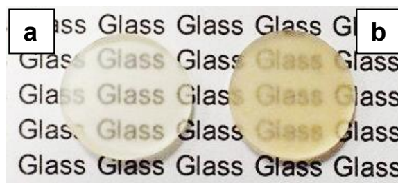
Figure 3.11 : Aspect du verre cristallisé (800 °C – 50 heures) (a) comparé au verre parent (b), échantillons non-polis (épaisseur \approx 1 mm).
