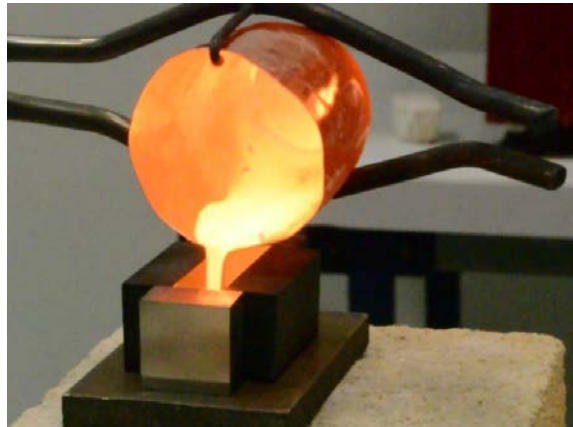
Figure 2.4 : Coulage du liquide précurseur dans un moule en inconel 600.
