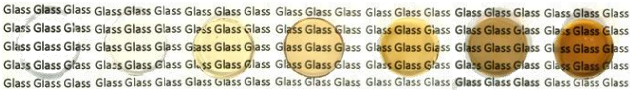
Figure 2.10 : Transparence et couleur des verres à l'œil nu, de gauche à droite x = 0,00 ; 0,05 ; 0,10 ; 0,15 ; 0,20 ; 0,25 ; 0,30 , (épaisseur des éprouvettes de 1 mm, diamètre de 10 mm).
