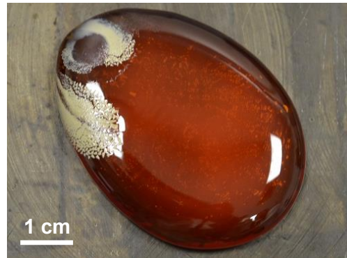
Figure 3.4 : Verre x = 0,30 juste après avoir été coulé sur un moule chaud (encore chaud, T > 800^{\circ}\text{C} ), début de cristallisation à la surface. Le verre est encore chaud.
