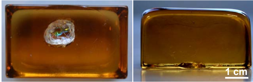
Figure 2.6 : Eclat au niveau de la surface inférieure d'un verre de composition x = 0,20 en contact avec le moule porté à 800\text{ }^{\circ}\text{C} ( x = 0,20 ).
