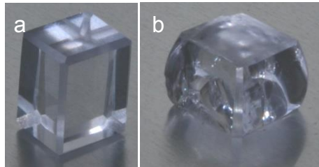
Figure 2.47 : Eprouvette avant (a) et après (b) essai de fluage.
