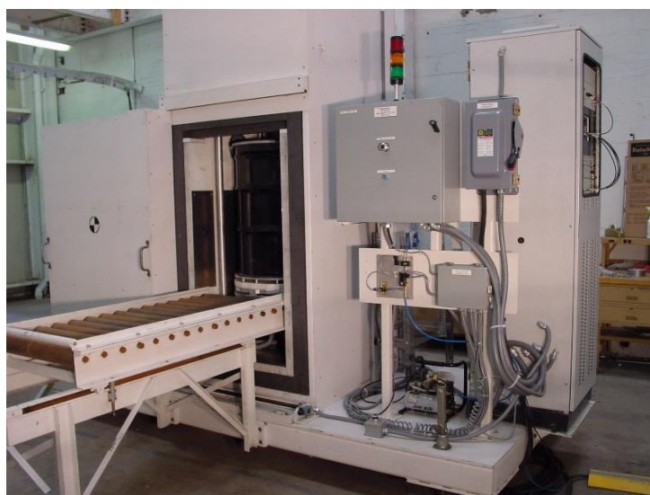
Figure 10. Prototype de la cellule d'activation neutronique pulsée de Westinghouse [Dulloo04].
