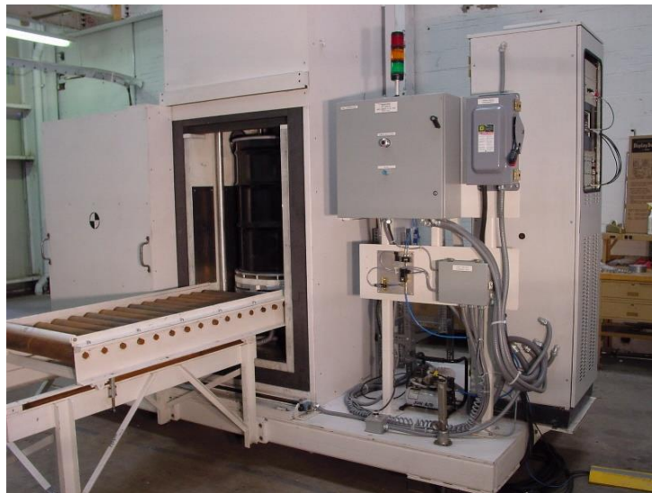
Figure 10. Prototype de la cellule d'activation neutronique pulsée de Westinghouse [Dulloo04].
