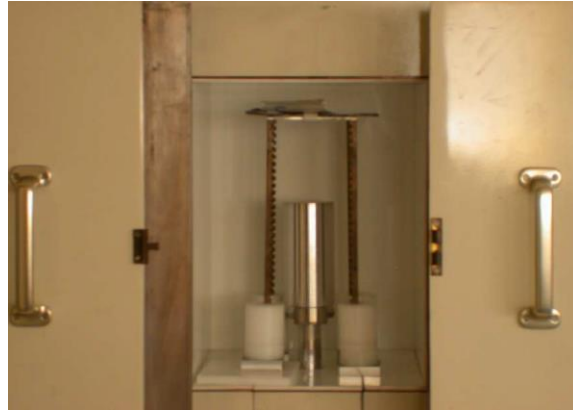
Figure 14. Dispositif de spectrométrie gamma à bas bruit de fond [Clamond05].
