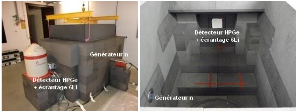
Figure 16. Cellule MEDINA (extérieure et intérieure) [Mauerhofer14].
