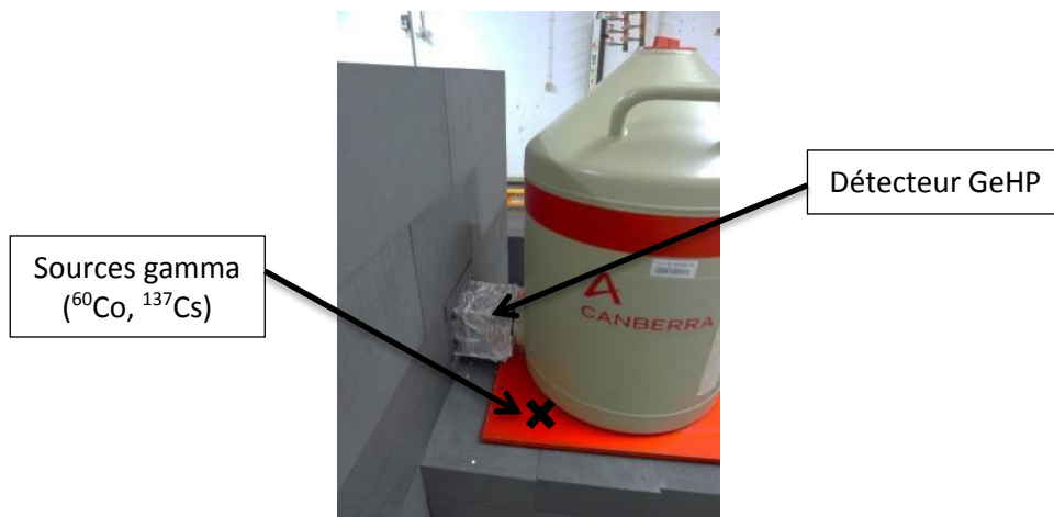
Figure 54. Positionnement des sources gamma ponctuelles ( ^{60}\text{Co} , ^{137}\text{Cs} ) par rapport au détecteur GeHP.
