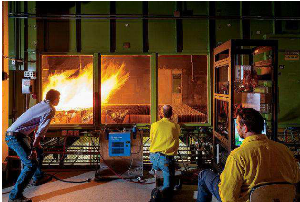
FIGURE 1.12 – Tunnel à feu du laboratoire de l'Intermountain Fire Sciences
