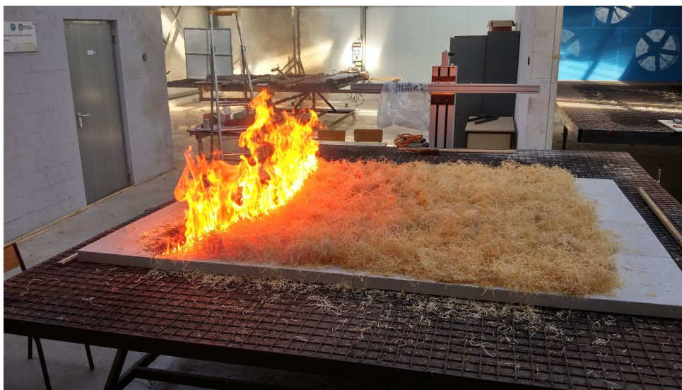
FIGURE 2.27 – Exemple d'une propagation sur la surface en béton cellulaire
