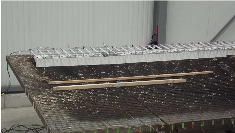
FIGURE 2.1 – Dispositif de mesure du ROS par photorésistances
