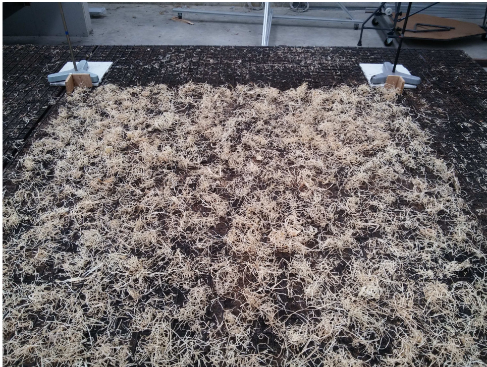
FIGURE 2.40 – Exemple de répartition de la frisure de bois pour une charge de 0,1 \text{ kg.m}^{-2}
