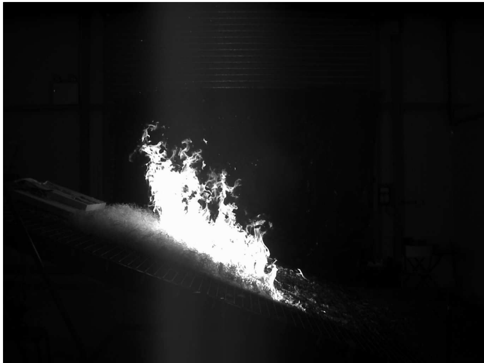
FIGURE 2.49 – Photo d'un test de propagation pour une pente de 20°
