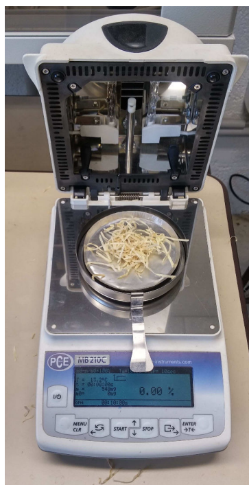
FIGURE 2.7 – Appareil MB-210C de chez PBE instruments pour mesurer la teneur en eau du combustible
