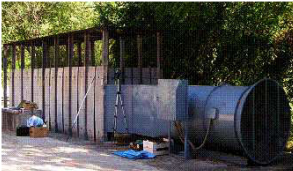
FIGURE 1.16 – Tunnel à feu du CIFOR INIA en Espagne
