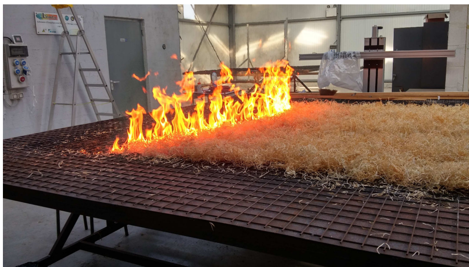
FIGURE 2.2 – Exemple d’un allumage en ligne
