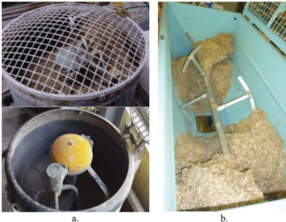
Figure 5-1: Différents types de malaxeur a. classique et b. adapté au béton de chanvre
