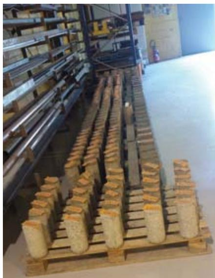
Photo 5-1: Séchage des éprouvettes à l'air libre
