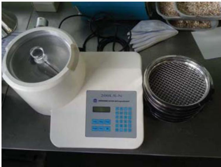
Figure 1-12: Le dispositif expérimental pour la méthode alpine [57].
