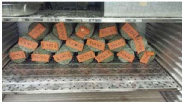
Photo 5-2: Séchage des éprouvettes à l'étuve
