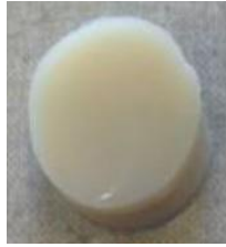
Figure V.20: Photo du gel d'alginate de calcium insoluble dans l'eau obtenu expérimentalement
