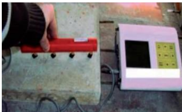
Figure I.8: Mesure de la résistivité électrique d'une structure en béton à l'aide d'un porte-électrodes
