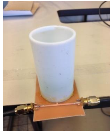
Figure V.13: Résonateur stub en contact avec les solutions/ gels, placé(e) dans la cuve
