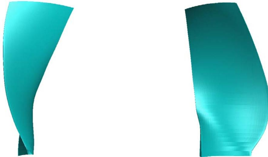
**figure 69** *Modèle d'aube creuse en éléments SHB8.*
