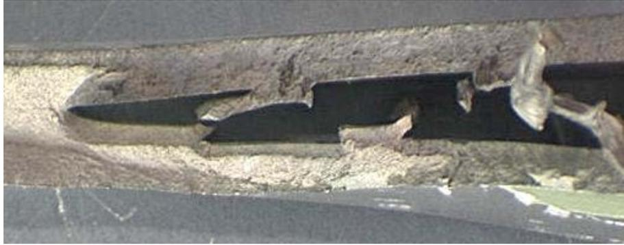
**figure 21** *Rupture des raidisseurs de l'aube adjacente par cisaillement et flambage.*
