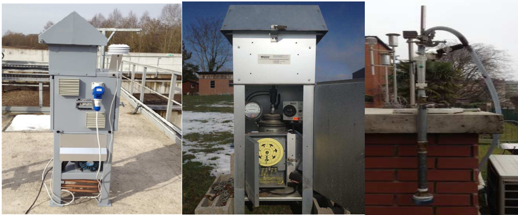
Figure 22: Photo des différents types de préleveurs actifs (Zambelli, TISCH et tête de prélèvement du dispositif expérimental)
