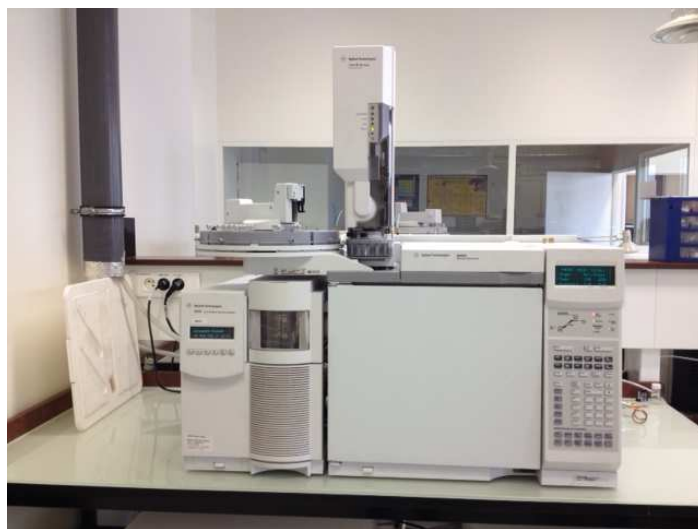
Chromatographe en phase gazeuse couplée à un spectromètre de masse en tandem (GC-MS/MS)
