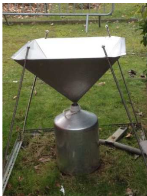
Figure 25: Collecteur de dépôts atmosphériques totaux (jauge OWEN)
