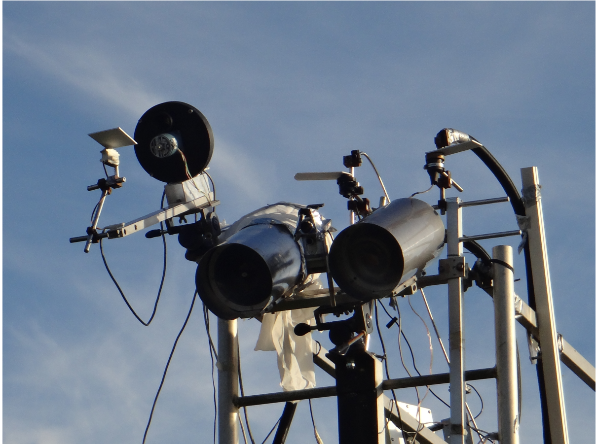
FIGURE 2.16 – Photographie de Fluocam, de Blue-Lidar et des fibres optiques d'entrée d'Airflex et de Spectro-Flex. On peut voir les références commutables de Fluocam, d'Airflex et de Spectro-Flex.
