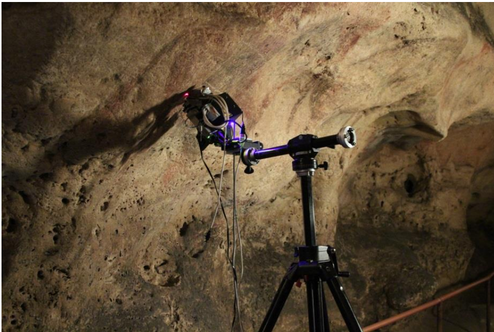
Figure IV. 35 : Spectromètre de FX portable face au bison 43 (© Gay M./LAMS).
