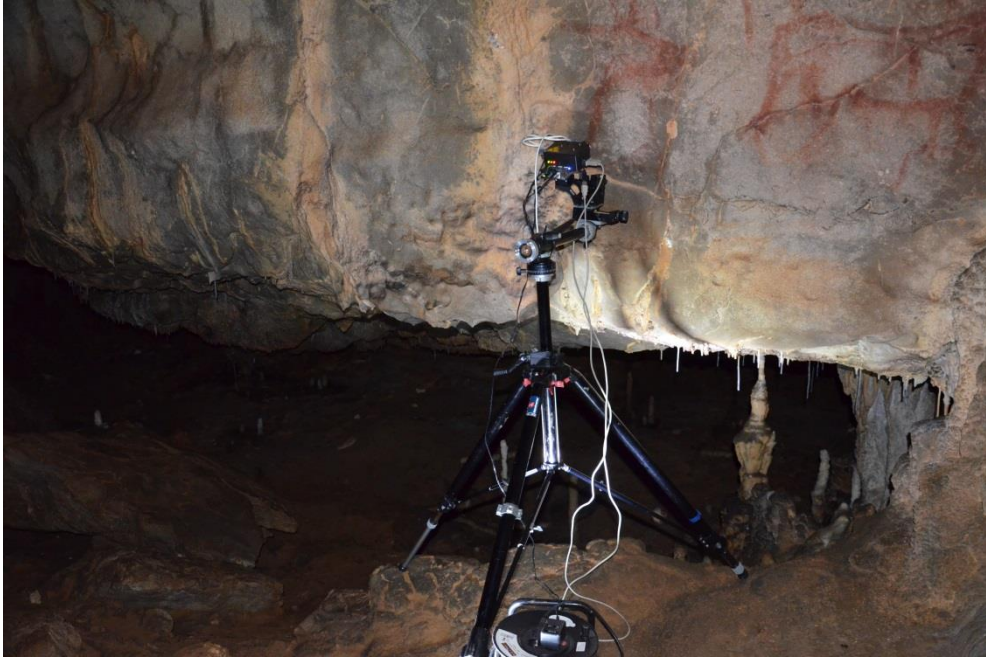
Figure III. 7 : Mise en œuvre du spectromètre de fluorescence X portable pour l'analyse du panneau aux cinq figures animales (© Gay M./LAMS).
