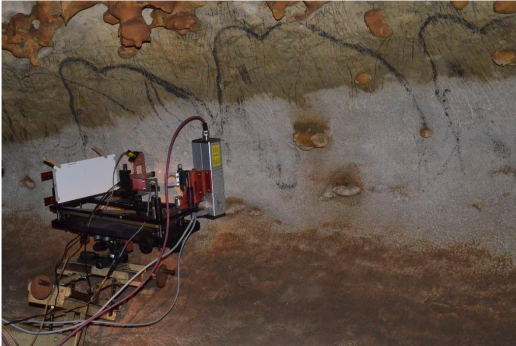
Figure IV. 9 : Dispositif instrumental couplant la DRX et la FX, mis en œuvre face à la Frise des dix mammoths (© Gay M./LAMS). Cet appareil est constituée d'une source de rayons X iMOX micro-foyer de IFG (30W, 40keV et 700 \mu A) à anode en cuivre isolée de l'extérieur par une fenêtre en béryllium de 0,01 mm ; d'optiques polycapillaires pour un faisceau parallèle de 3mm de diamètre ; d'un détecteur SDD ( Silicon Drift Detector ) de 7 mm 2 ; d'un dispositif supportant la plaque-image sur laquelle s'impriment les anneaux de diffraction [Gianoncelli A. et al. , 2008].
