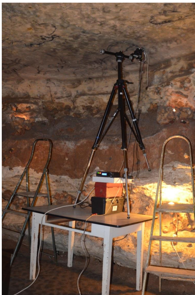
Figure IV. 13 : Spectromètre de FX portable analysant le bouquetin 102 (© Gay M./LAMS).
