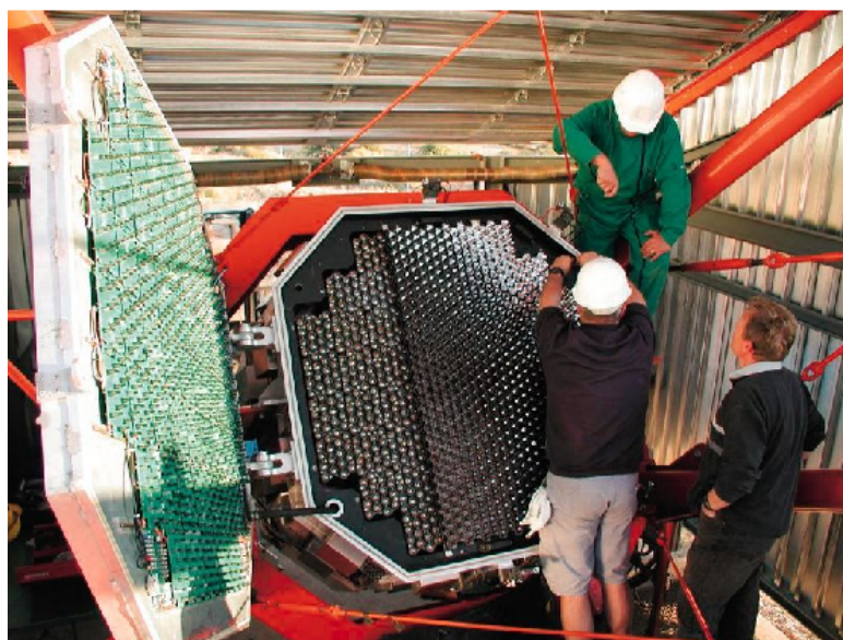
FIGURE 2.9 – Image d’une caméra de H.E.S.S. pendant la mise en place des cônes de Winston.
