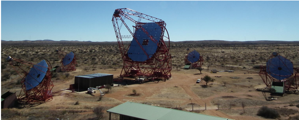
FIGURE 2.5 – Photographie du site de H.E.S.S. sur le plateau Khomas en Namibie. Les quatre télescopes aux extrémités du réseau sont répartis selon un carré de 120 m de côté. Un cinquième télescope plus large est placé au centre depuis 2012.
