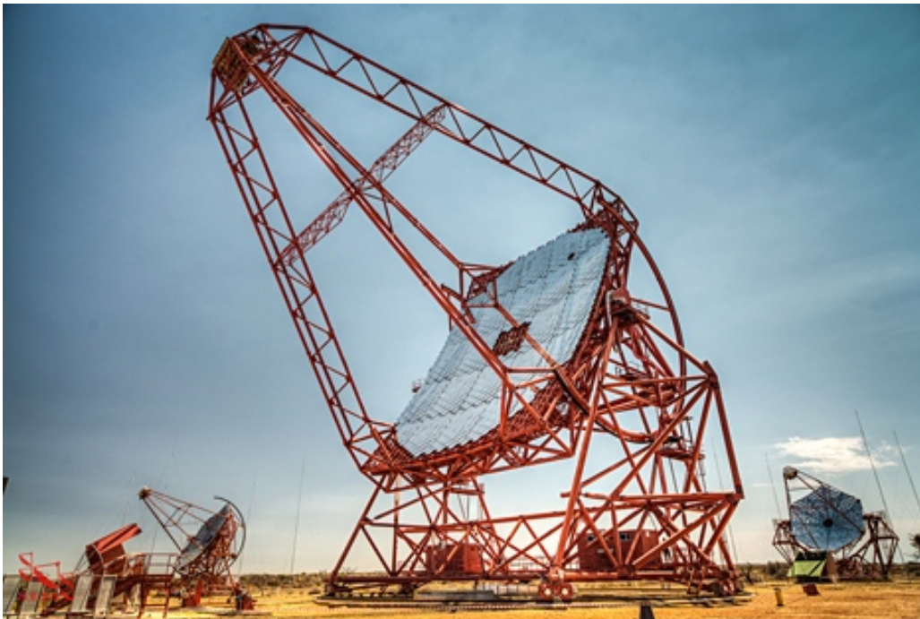
FIGURE 2.11 – Image du cinquième télescope (CT5) au centre du réseau H.E.S.S. en Namibie. Sa mise en service en septembre 2012 permet de baisser le seuil en énergie et d'augmenter la sensibilité du réseau. L'expérience est appelée H.E.S.S. II.
