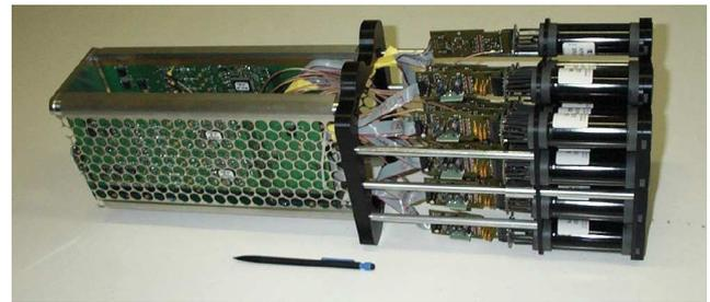
FIGURE 2.10 – *Gauche* : Efficacité quantique en fonction de la longueur d’onde des PMs des caméras de H.E.S.S.. Les points noirs représentent différents PMs, et la courbe rouge la valeur moyenne. Cette figure est extraite de [150]. *Droite* : Image d’un tiroir installé dans les caméras de H.E.S.S.. Un tiroir comprend 16 PMs (sur la droite) et les cartes électroniques.
