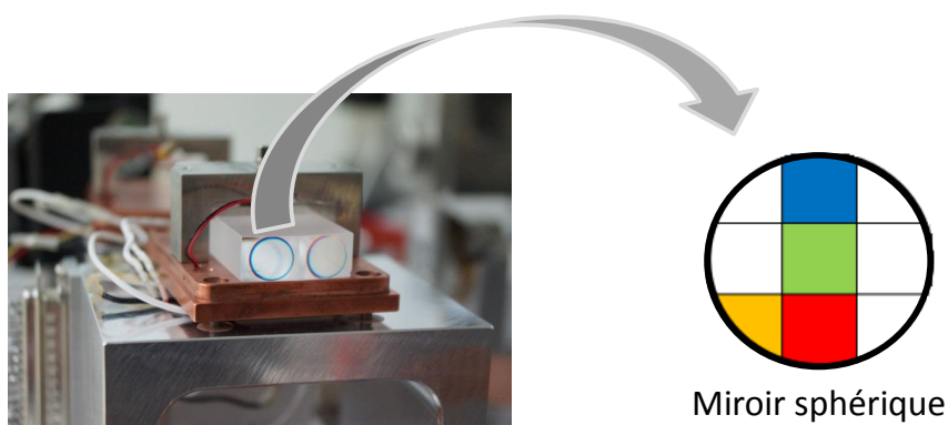
FIGURE 5.7 – Positions du faisceau sur le miroir sphérique. Chaque couleur correspondant à une position étudié du faisceau sur la face.
