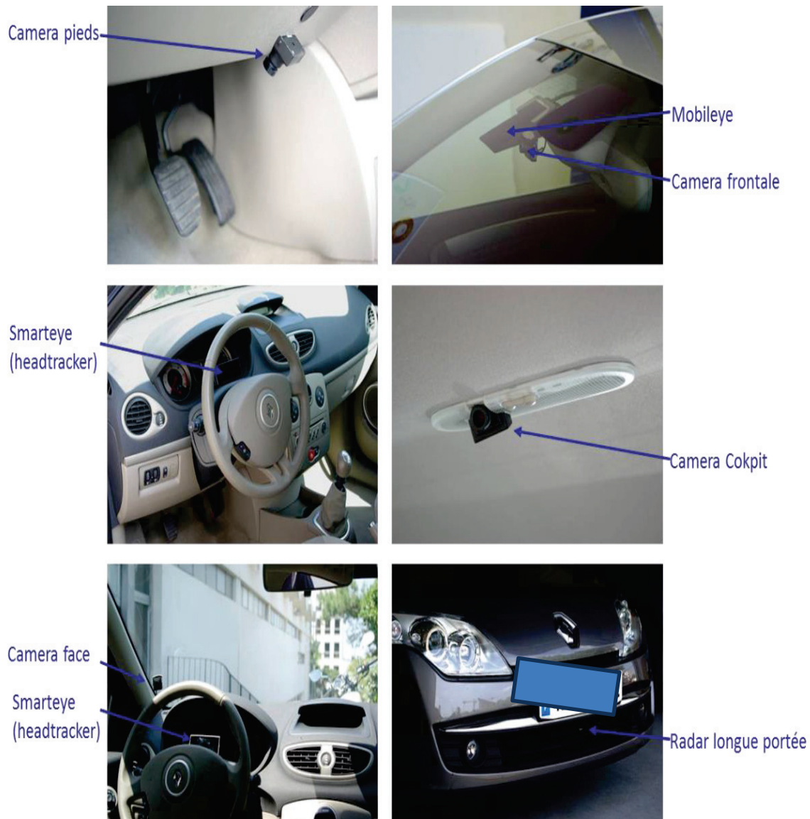
Figure III.3 : Instrumentation du véhicule d'expérimentation de CEESAR
