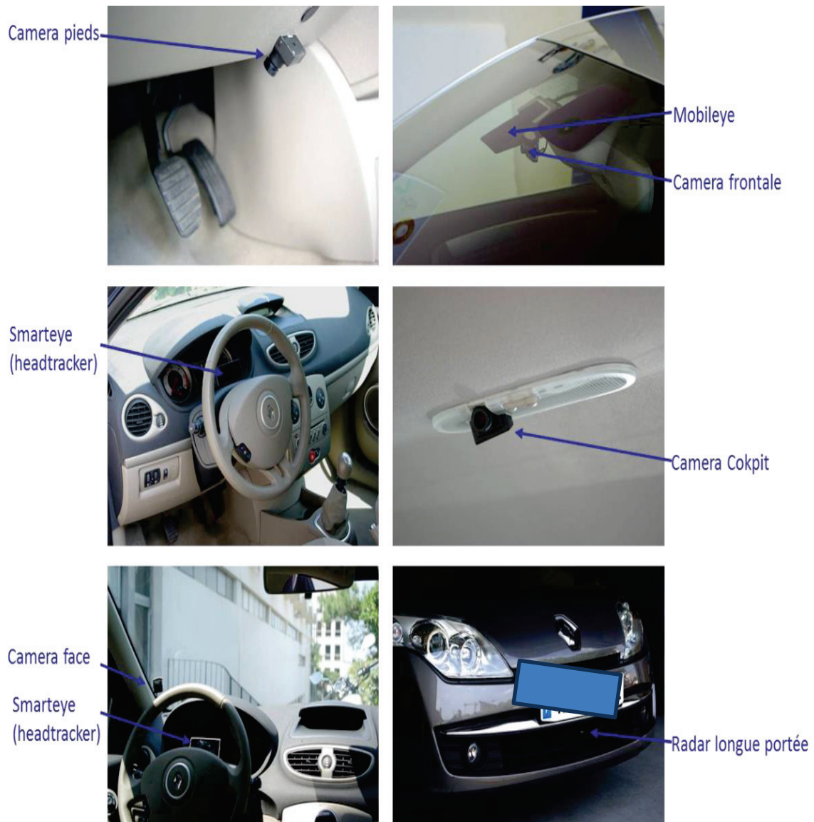
Figure III.3 : Instrumentation du véhicule d'expérimentation de CEESAR
