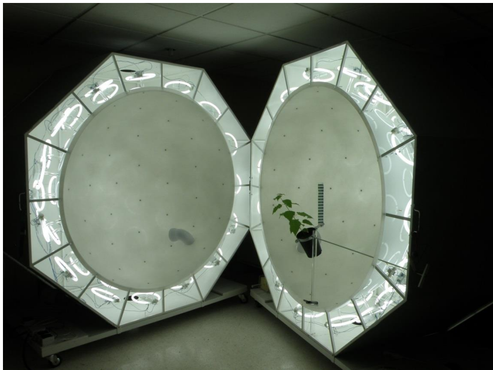
Figure 6. Représentation du dispositif de lumière isotrope
