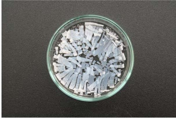
**FIGURE B.2** – *Film de Ludox<sup>®</sup> délaminé après séchage.*
