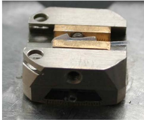
**FIGURE B.6** – Porte-échantillon permettant l'approche par AFM de la tranche d'un film, ici, un film colloïdal de  $100\ \mu\text{m}$  d'épaisseur. Montage réalisé par C. Blot, LIONS, CEA-Saclay.
