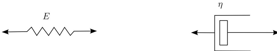
**FIGURE II.9** – Représentations schématiques des comportements rhéologiques idéaux : le ressort hookéen et le piston newtonien.
