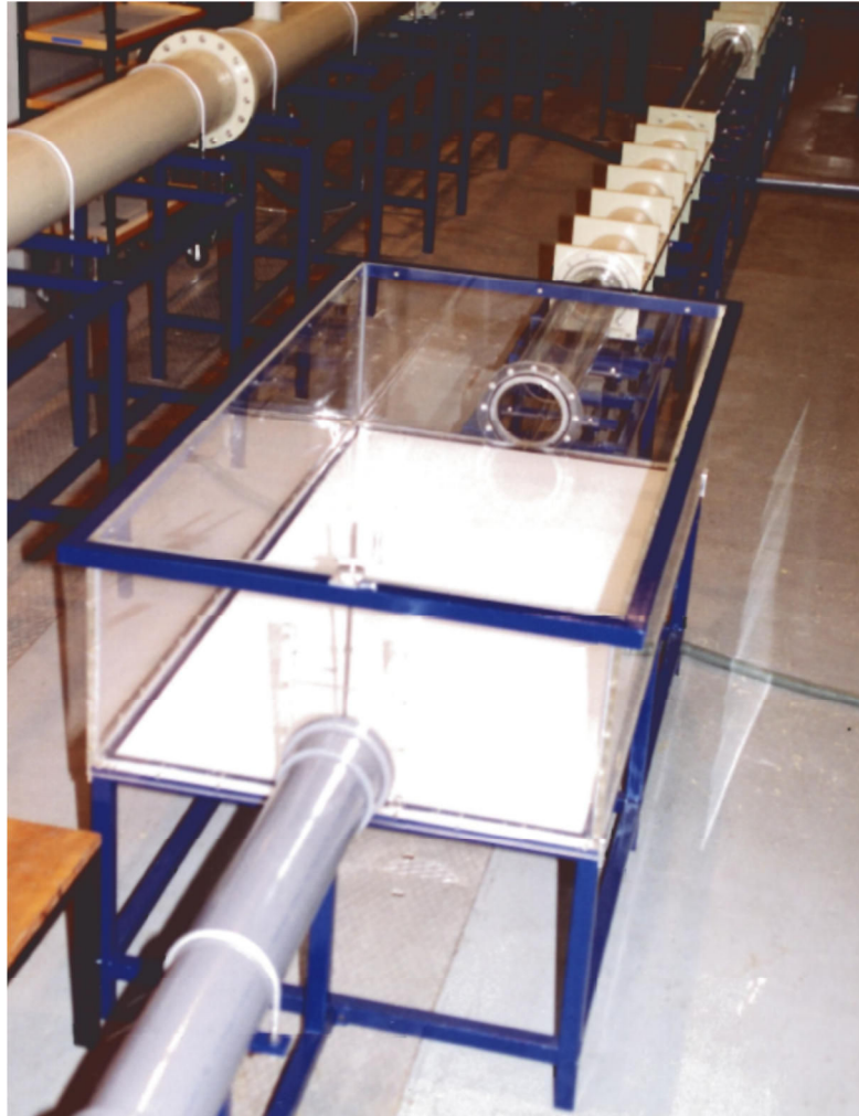
Figure 1-6 : Modèle réduit de bassin utilisé par Stovin & Saul (1994) et Stovin (1996), d'après Stovin (1996)
