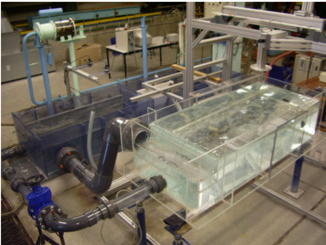
Figure 1-7 : Modèle réduit de bassin utilisé par Dufresne (2008), d'après Dufresne (2008)
