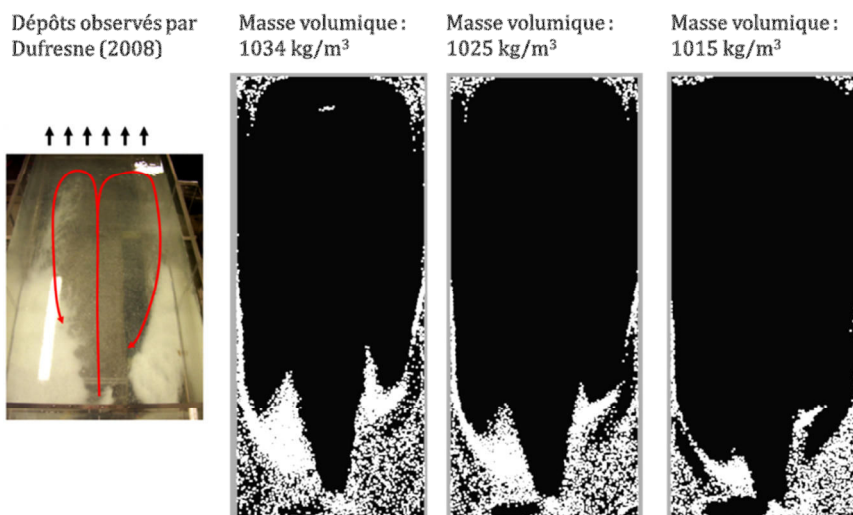
Figure 3-54 : Sensibilité des zones de dépôt en fonction de la masse volumique des particules pour l'expérience Exp20
